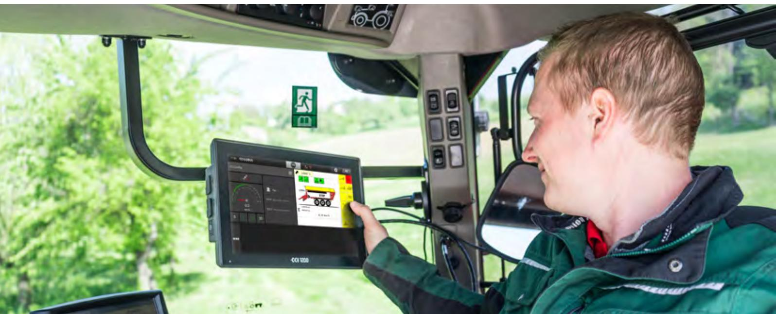
CCI 1200 – un terminale per qualsiasi macchina compatibile con ISOBUS. Il grande schermo e la disposizione flessibile delle macchine, telecamera e Section Control divertono tutto l'anno.
