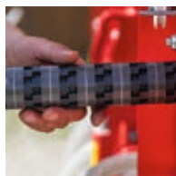
Roue de distribution dosage petites graines
