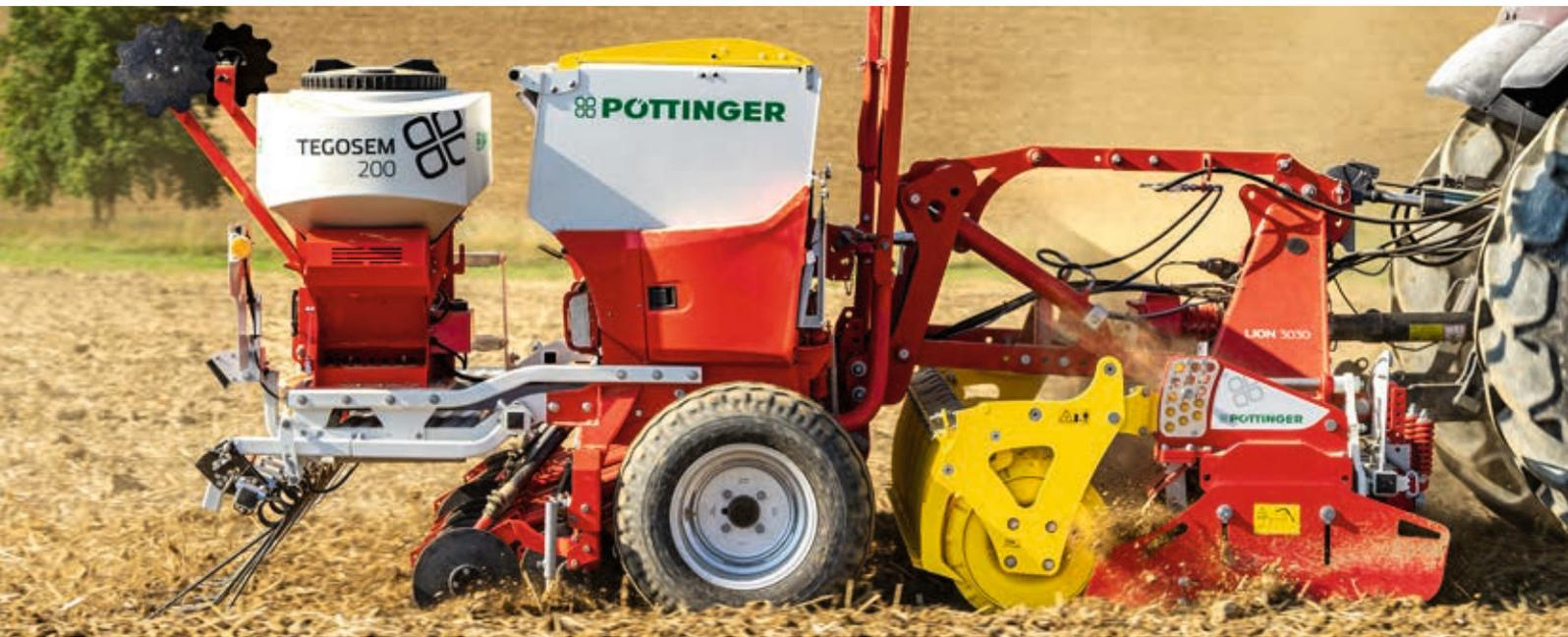
En combinant les semoirs et les machines de travail du sol avec le TEGOSEM, deux opérations sont réalisées en un seul passage. Il s'agit d'une possibilité rapide et économique d'ajouter des cultures intermédiaires ou autres jusqu'à 40 kg/ha. Il en résulte de multiples cas d'application avec différentes machines.
