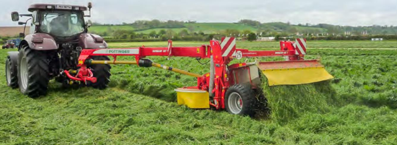
Наши прицепные косилки NOVACAT T с рабочей шириной 3,04 м / 3,46 м отлично подходят для использования с небольшими тракторами. Прицепной вариант с подвеской не требует подъемной силы, а значит вы также можете работать на менее мощных тракторах. Таким образом, вы экономите топливо.
