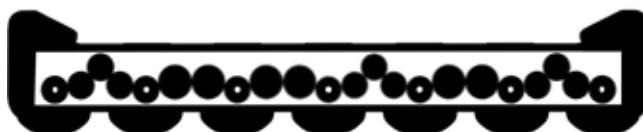
Специально шлифованная поверхность шестерен обеспечивает плавный ход в масляной ванне, что существенно снижает уровень шума.
