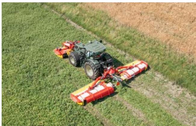
Bei zwei Fahrspuren mähen Sie rund 19 m, legen aber die beiden Schwade innerhalb von ca. 12 m ab. Das CROSS FLOW System erledigt somit bereits einen Teil der Schwadarbeit. Das ideale Folgegerät ist ein Vierkreisel-Mittenschwader. So reduzieren Sie Ihre Überfahrten maßgeblich und schonen den Boden und Ihr Futter. Außerdem sparen Sie wertvolle Zeit und Kraftstoff.
