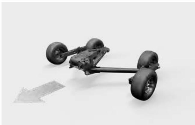
Oba shrnovače jsou standardně vybaveny čtyřkolovým podvozkem s tandemovými nápravami. Spolu s pneumatikami 18,5 x 8,5-8 dokonale vyrovnávají nerovnosti terénu. To zaručuje klidný chod jak v terénu, tak na silnici.
