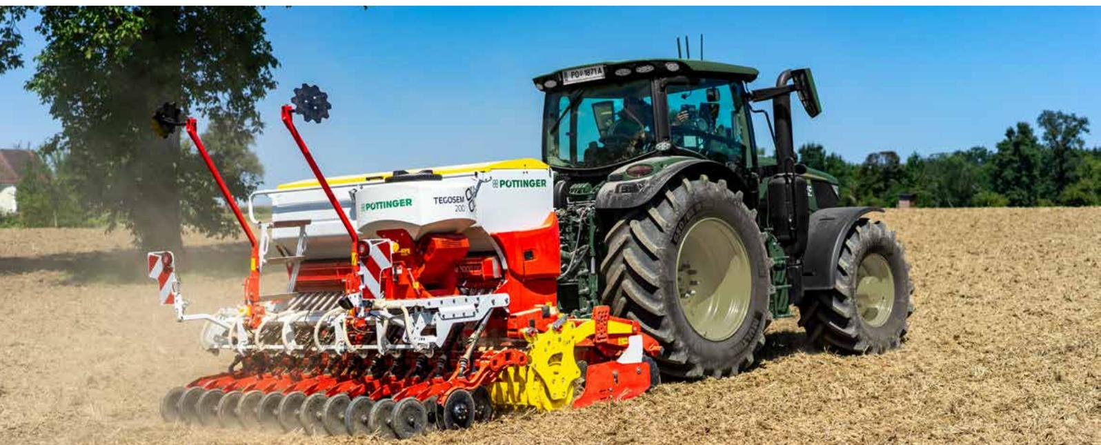
Il versatile contenitore della semente TEGOSEM combina lavorazione del terreno e semina di colture intercalari e sottosemine in un'unica fase di lavoro, riducendo tempi di lavorazione e costi. TEGOSEM si può combinare sia con macchine portate che semiportate.
