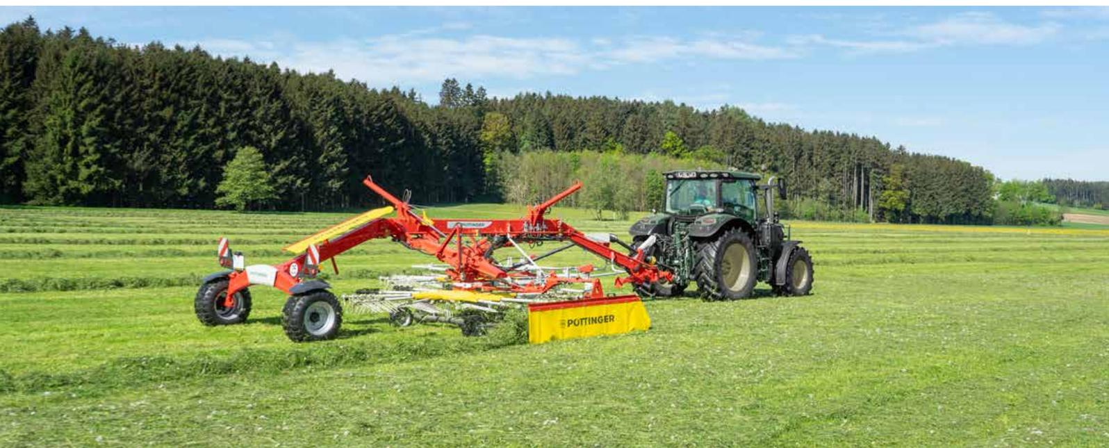
Rastrellamento preciso ed una presenza di impurità nel foraggio ridotta al minimo – queste sono le caratteristiche distintive dei ranghinatori TOP di PÖTTINGER. L'elemento basilare per riuscirci è costituito da un adattamento ottimale al terreno grazie alla ruota tastatrice MULTITAST, unica nel suo genere. La tecnologia costruttiva dei robusti giranti TOPTECH PLUS di grandi dimensioni garantisce inoltre una longevità elevata ed un notevole comfort di manutenzione.
