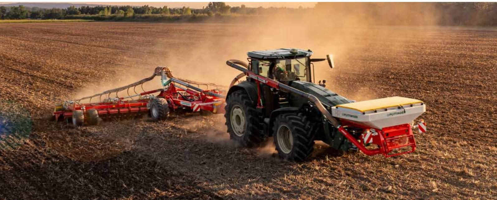
Il contenitore AMICO F, in combinazione con varie macchine per la lavorazione del terreno, offre la possibilità di depositare fertilizzante, risp. fertilizzante microgranulare, colture intercalari oppure due prodotti contemporaneamente. Con una capacità di 1.700, risp. 2.400 litri ed una suddivisione del volume del contenitore di 60:40 viene garantito un ampio spettro d'impiego.
