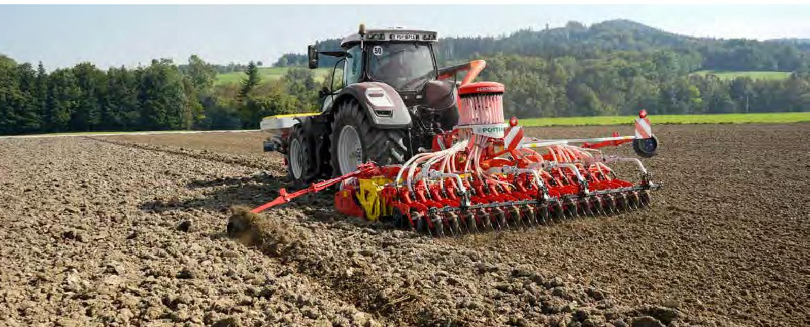
PÖTTINGER con la seminatrice con contenitore frontale AEROSEM FDD amplia la sua gamma di seminatrici pneumatiche per combine con macchine con larghezza di lavoro fino a 6 m.
