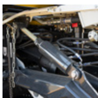
Гидравлическое складное дышло (с амортизацией)
