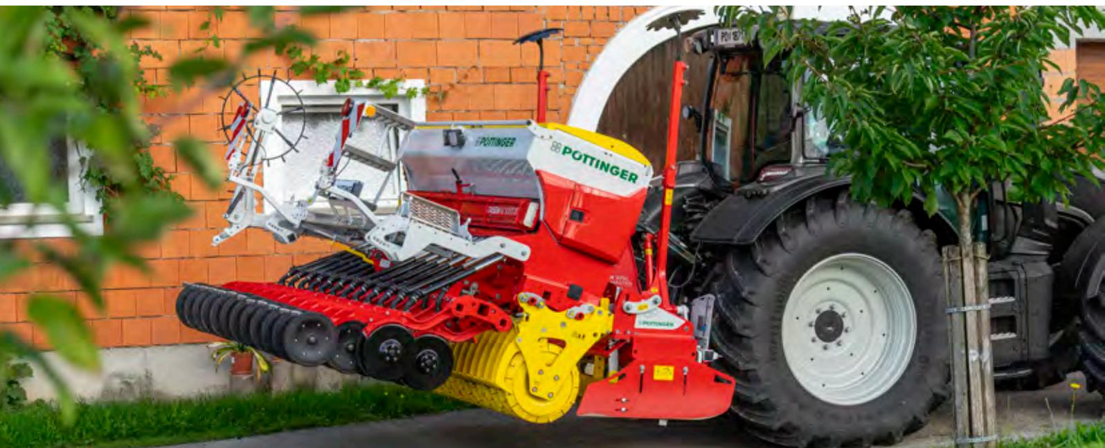
Наши ротационные бороны с жесткой рамой разделены на три различных модельных ряда. Самая большая разница заключается в размерах деталей и подшипников различных вариантов редуктора, которые рассчитаны на разную мощность трактора. Все модели имеют общие параметры настройки для достижения идеального результата работы.
