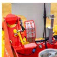
**Ajuste hidráulico de la profundidad de trabajo**
