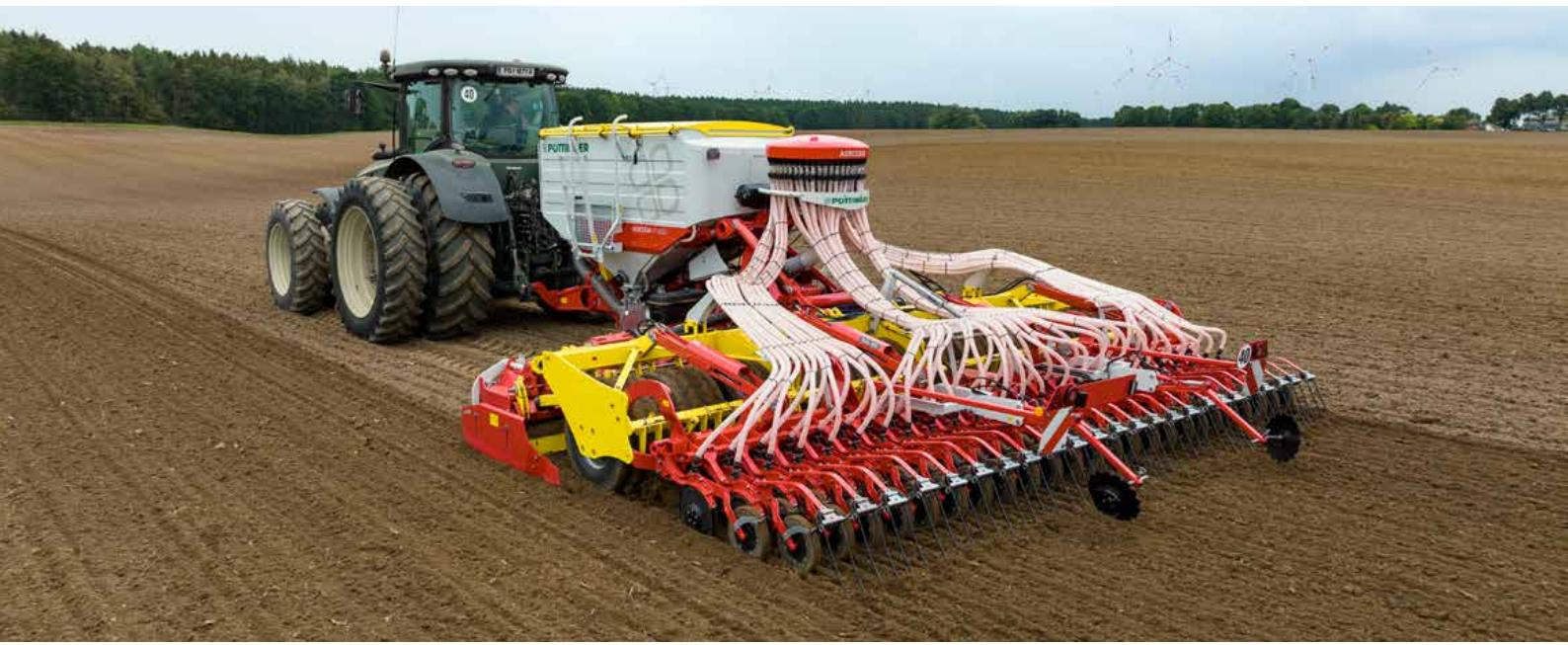
Tažený secí stroj AEROSEM kombinuje aktivní přípravu sečového lůžka rotačními branami LION, opětovné utužení pomocí válce a uložení osiva botkou DUAL DISC. Koncept taženého secího stroje s rotačními branami byl vyvinut pro lehké až nejtěžší typy půd a je rozšířen o komfortní ovládání Profiline. To umožňuje pohodlné ovládání všech hydraulických funkcí včetně nastavení přitlaku botek z kabiny řidiče.
