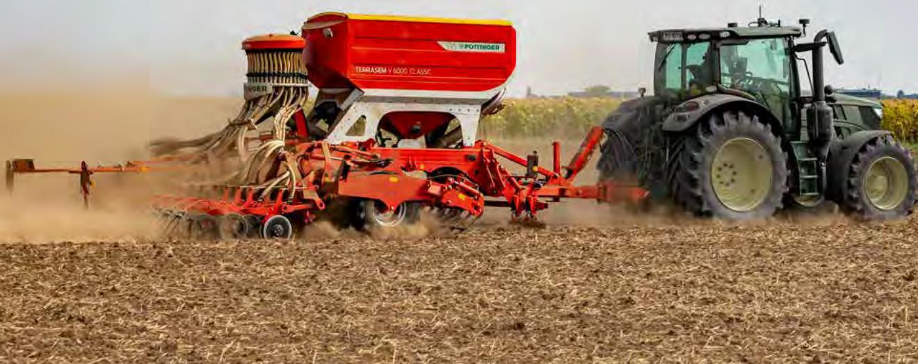
Modely TERRASEM CLASSIC bez čelních nástrojů pro zpracování půdy nabízí výkonnostní technologii uložení osiva. Minimalizační technologie setí s menší energetickou náročností. Díky optimálnímu přizpůsobení secí lišty půdě a jedinečnému pneumatikovému válci je dosaženo dokonalého ukládání osiva v požadované hloubce.
