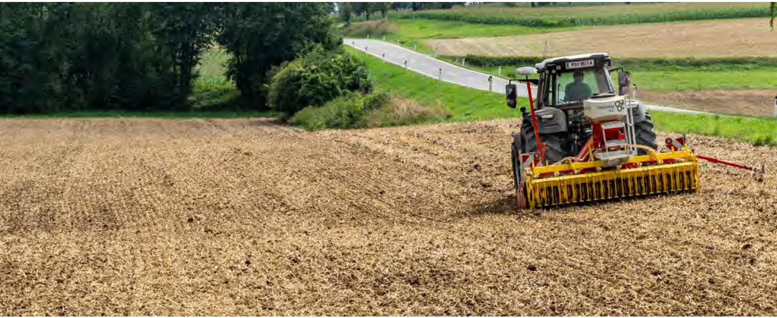
Dokonale připravené seťové lůžko se vyznačuje rovným horizontem zpracování, zpětným utužením a vhodným podílem jemné půdy. To vytváří optimální podmínky pro klíčení a rovnoměrný proces růstu rostlin.
