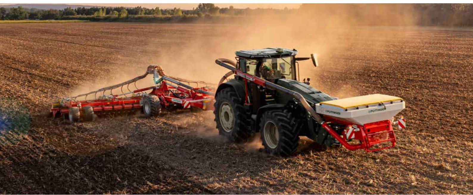
Čelní zásobník AMICO F ve spojení s různými zemědělskými stroji nabízí možnost aplikace hnojiva nebo mikrogranulí, meziplodin nebo dvou komponent současně. S objemem 1 700 nebo 2 400 litrů a rozložením objemu 60:40 je široká škála použití zaručena.
