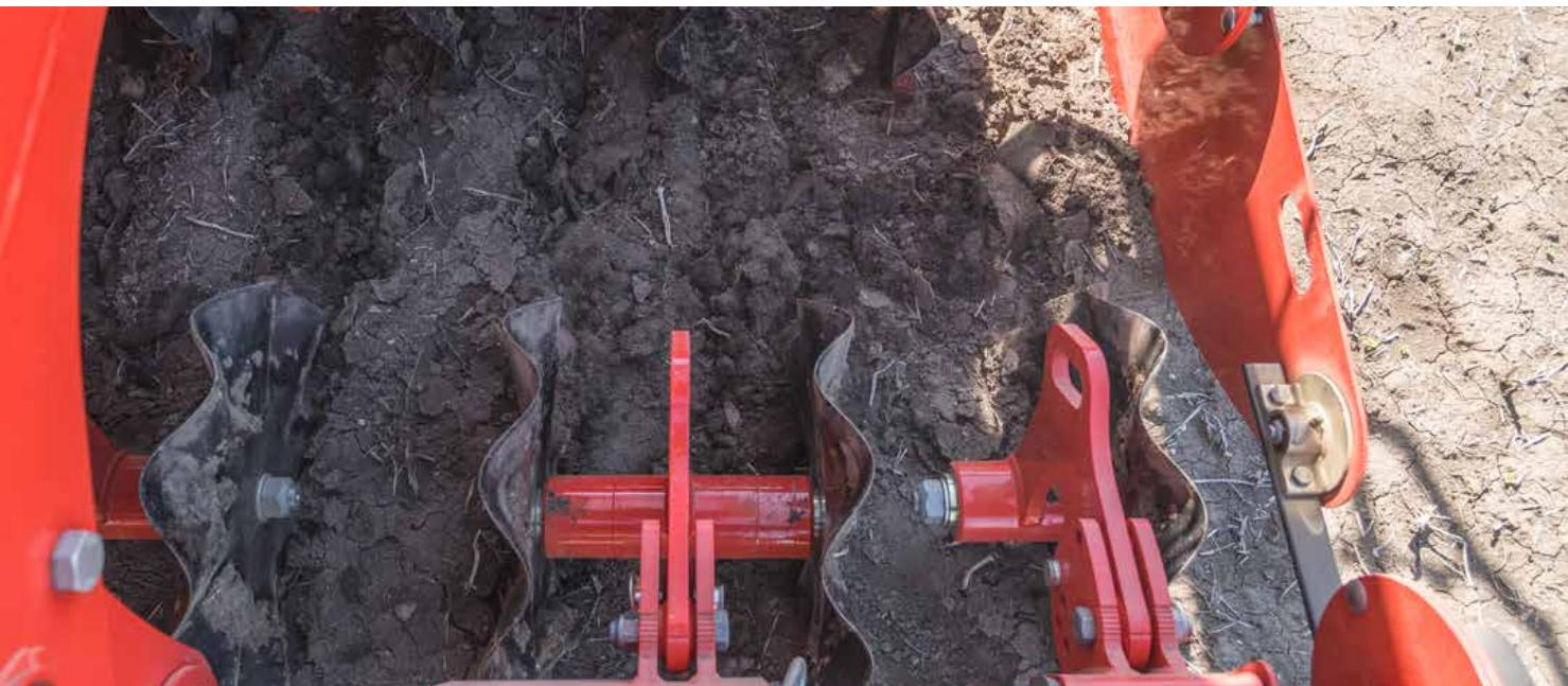
Bezúdržbový systém WAVE DISC je tvořený tvarovanými disky o průměru 510 mm s roztečí 12,5 cm nebo 16,7 cm. Plynulé nastavení pracovní hloubky. Systém redukovaného zpracování půdy v pásech představuje také účinné protierozní opatření. Vhodné především pro oblasti s extrémními podmínkami – těžké, mokré a lepivé půdy. WAVE DISC jsou k dispozici pro všechny modely secích strojů TERRASEM.
