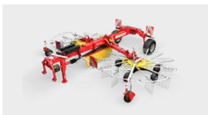
Středové shrnovače jsou charakteristické svou rovnoměrnou a vzdušnou tvorbou řádku. Co do šířky, tvaru a rozložení pokládají středové shrnovače přesný řádek pro následné sklizňové stroje. Charakteristickým znakem těchto shrnovačů je krátká konstrukce s vynikající manévrovatelností.
