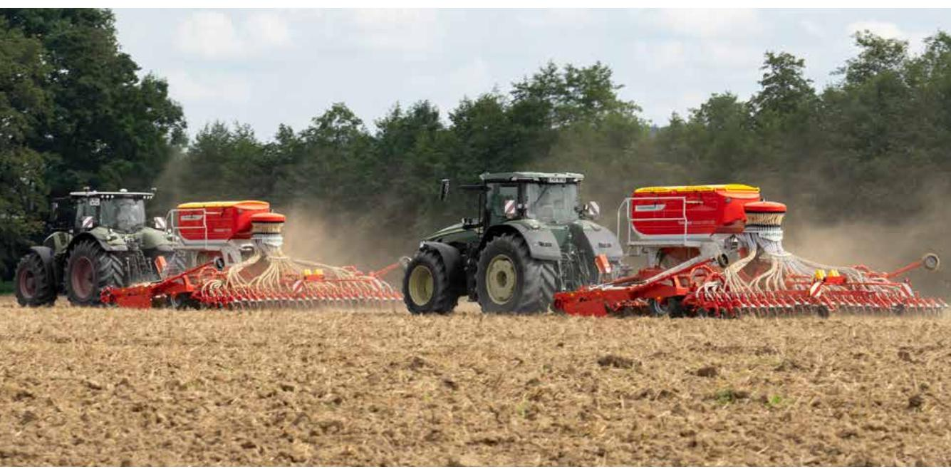
Koncept secích strojů TERRASEM firmy PÖTTINGER kombinuje pracovní kroky přípravy seťového lůžka s opětovným utužením a setí při jednom přjezdu. Dokonalé sladění efektivity a přesného uložení osiva dle Vašich potřeb. Rozšířené o komfortní ovládání Profiline je možné ovládat všechny hydraulické funkce pohodlně z kabiny řidiče.
