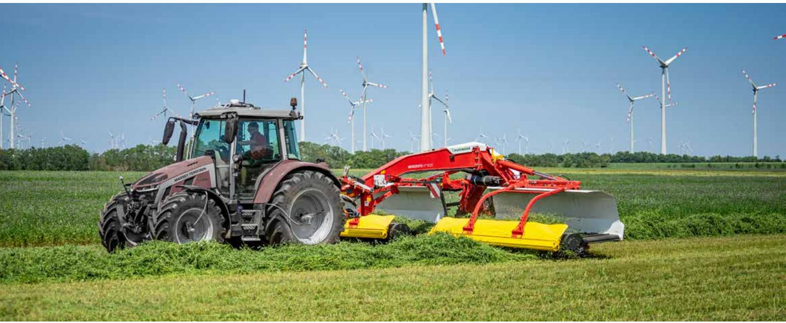
MERGENTO šetrně sbírá píci řízeným sběračem. Bez dalšího kontaktu se zemí je píce šetrně dopravována příčními pásy a odkládaná do řádku. Na zemi zůstávají nečistoty a kameny.
