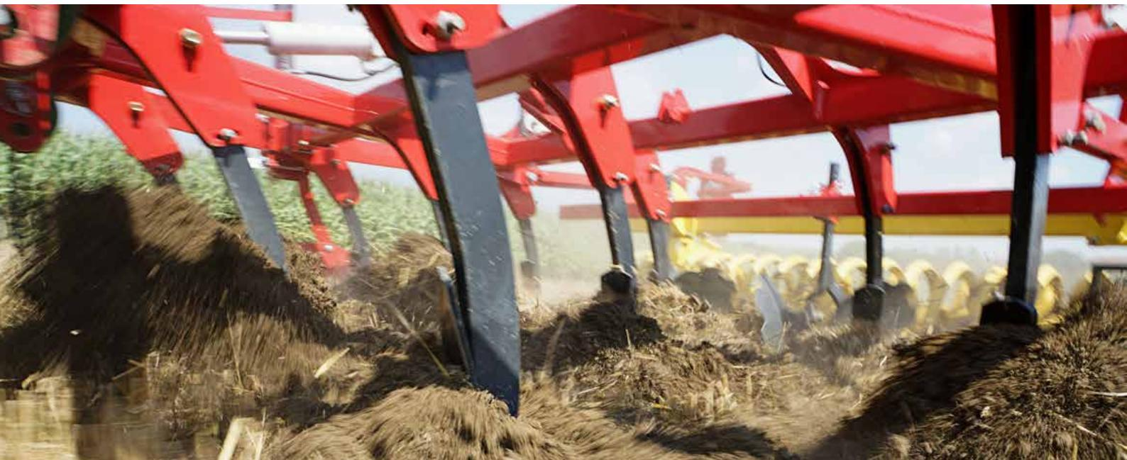
Klasickým nástrojem půdoochranného obdělávání je podmítáč. Vmísení zbytků po sklizni do povrchu půdy zvyšuje úrodnost půdy a chrání před erozí. Podmítáče SYNKRO ve dvou nebo třířadém provedení s různými opernými válci vytváří ideální podmínky klíčení semen plevele, vytroušeného obilí a meziplodin.
