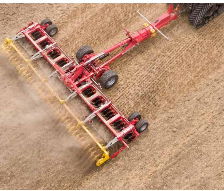
V moderní rostlinné výrobě nové systémy obdělávání půdy zintenzivnily trend k minimální míře tohoto obdělávání. Po žních je nutno posklizňové zbytky na celé ploše zpracovat tak, aby mohl proces rozkladu brzy započít. Tato směs rostlinných zbytků se zeminou vytváří optimální podmínky života pro živé organismy v půdě. TERRADISC je univerzálně použitelný a lze ho využívat i k úpravě osevních ploch přímo před setím.
