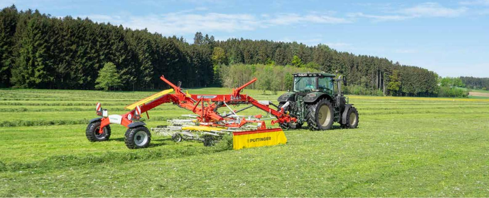
Shrnování s nejmenšími možnými ztrátami odolem a minimalizovaným znečištěním - to jsou shrnovače TOP od firmy PÖTTINGER. Ve spojení se systémem kopírování MULTITAST máte ideální základ pro čisté a šetrné shrnování. Jedinečný koncept TOPTECH PLUS (velký průměr vodicí dráhy i rozteč uložení ramen) pro dlouhou životnost a hospodárnost.
