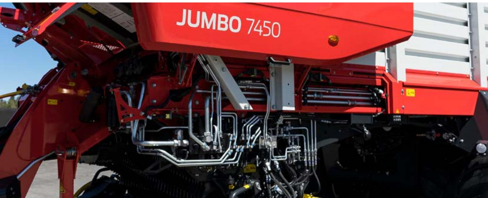
Durch die Trennung von Hydraulik und Elektrik ist der Ladewagen einfacher und besser zu reinigen.
