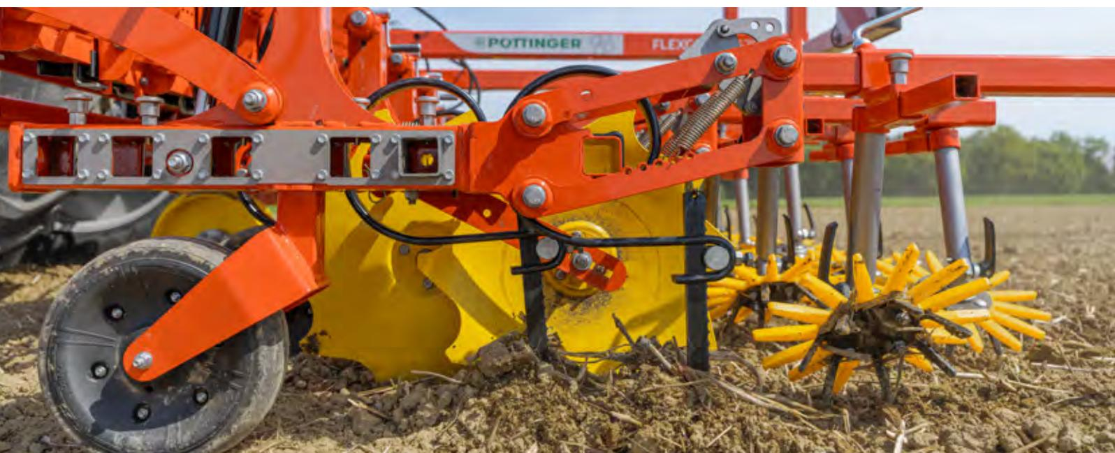
Les accessoires sont guidés au moyen d'un parallélogramme indépendant. Cela garantit un guidage optimal des contours. De plus, grâce au guidage sur parallélogramme, les doigts bineurs, ainsi que la herse à dents peuvent être relevés lorsqu'ils ne sont pas utilisés, ce qui évite un démontage laborieux.
