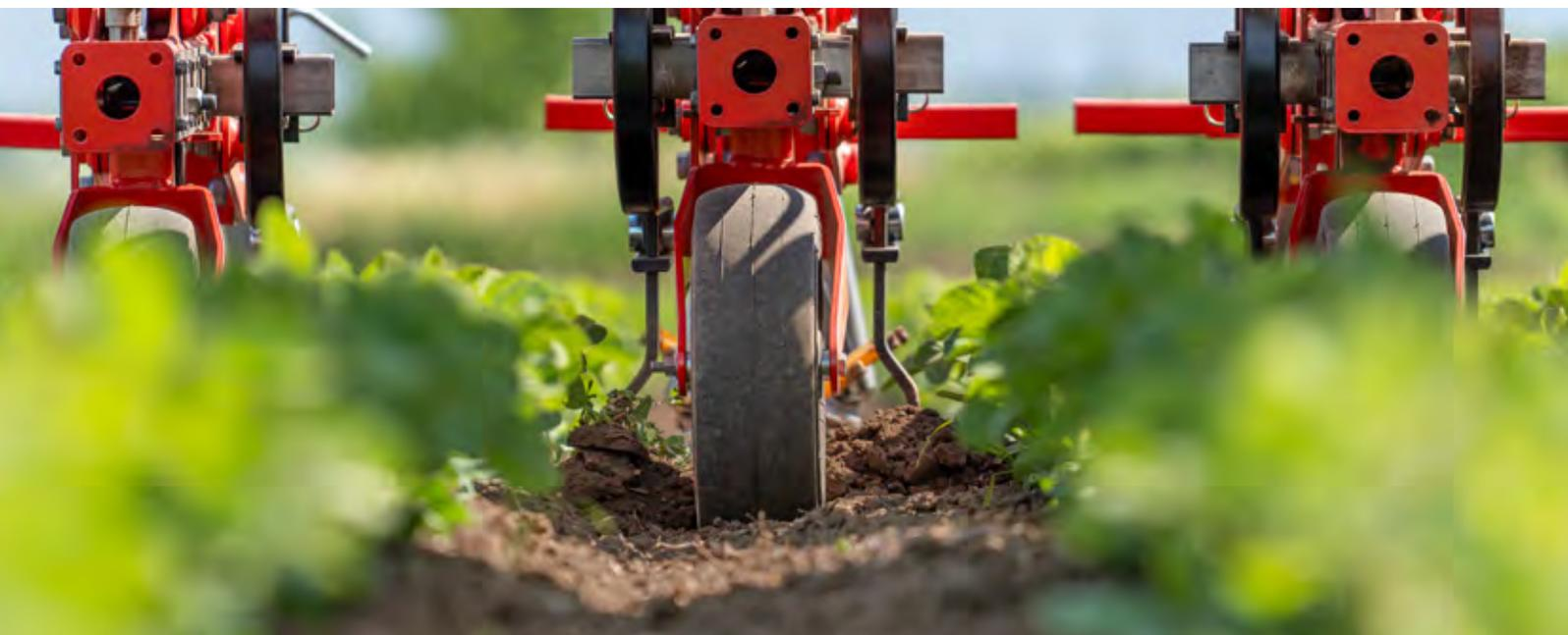
Pour un binage superficiel des cultures jusqu'à 5 cm de profondeur, des socs offrant de nombreuses options sont utilisés. La bineuse FLEXCARE est conçue de manière à ce que les socs puissent être remplacés rapidement et en fonction des besoins.
