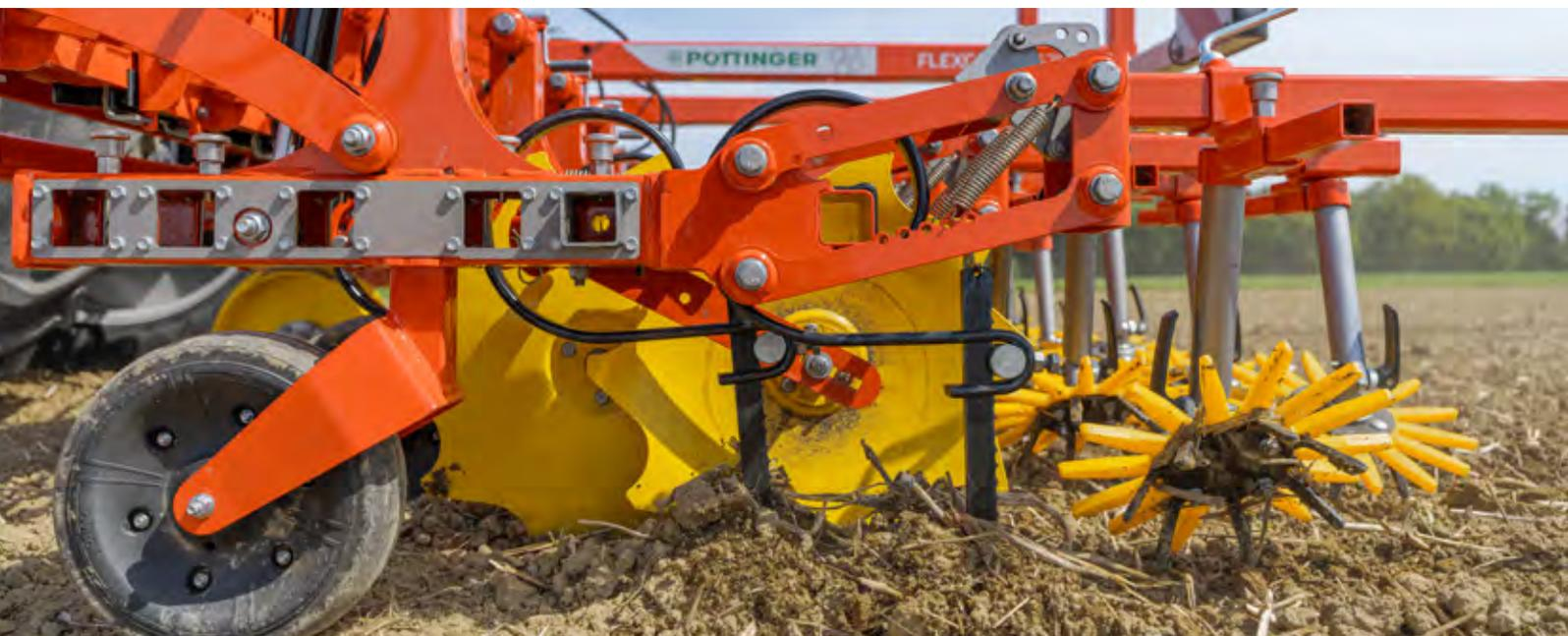
Las herramientas posteriores van guiadas por un paralelogramo separado. Esto garantiza una óptima guía del contorno. Además, gracias a la guía por paralelogramo, las azadas de dedos así como las rastras de púa se pueden levantar en posición de aparcamiento cuando no se usan, lo que evita el desmontaje.
