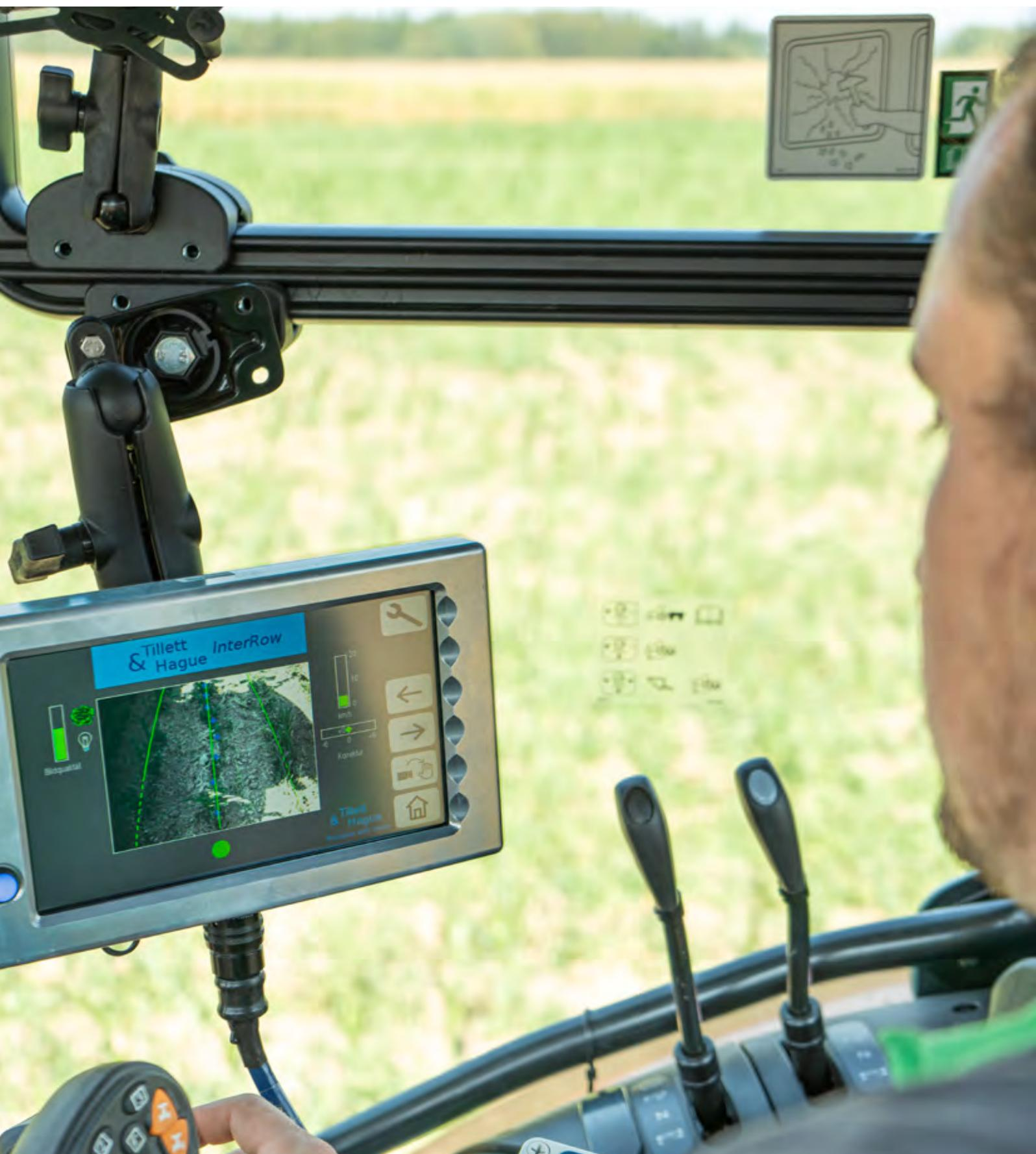
La elevación de los elementos de azada en la cabecera reduce solapamientos y laboreo múltiple. Existen dos posibilidades del control: Elevación central o elevación individual.
