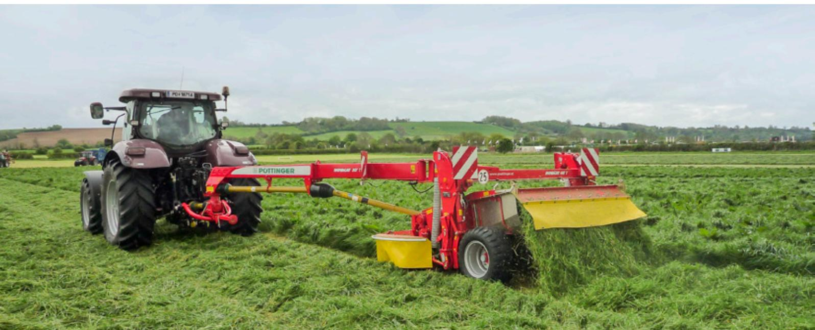
Nos faucheuses traînées NOVACAT T avec 3,04 m ou 3,46 m de largeur de travail sont parfaitement adaptés aux petits tracteurs. La version traînée avec chariot de transport nécessite moins de puissance de levage ce qui vous permet de l'atteler à des tracteurs moins puissants. C'est ainsi que vous économiserez du carburant.
