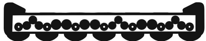
La surface des pignons spécialement polie garantit un fonctionnement silencieux dans le bain d'huile. Cela réduit considérablement le niveau sonore et augmente le confort au travail.
