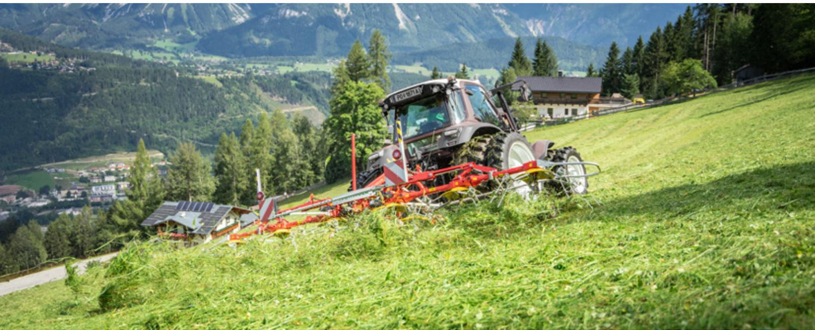
Leichtbauweise und perfekte Bodenanpassung stehen auch beim HIT V 6260 ALPIN an erster Stelle. Mit einer Arbeitsbreite (DIN) von 6,20 m und lediglich 530 kg Eigengewicht ist er ein schlagkräftiges Leichtgewicht. Der HIT V 6260 ALPIN ist standardmäßig mit einem Schwenkbock ausgestattet. Am Vorgewende sorgt HYDROLIFT für ausreichend Bodenfreiheit.
