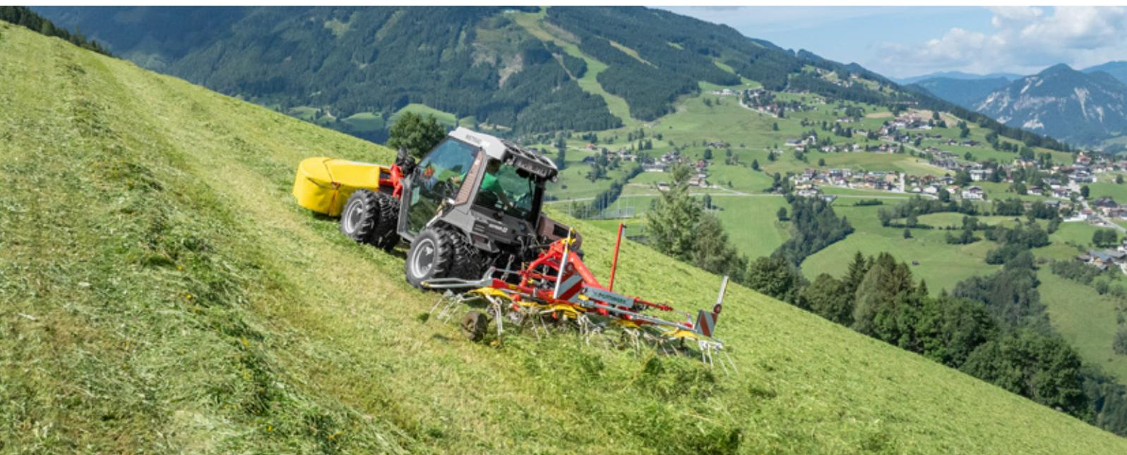
Les deux modèles HIT V ALPIN avec quatre toupies sont de vrais poids légers. La faneuse quatre toupies avec tête d'attelage fixe ne pèse que 320 kg. Le modèle avec tête pivotante ne pèse que 390 kg. Les deux modèles atteignent une largeur de travail de 4.20 m (DIN).
