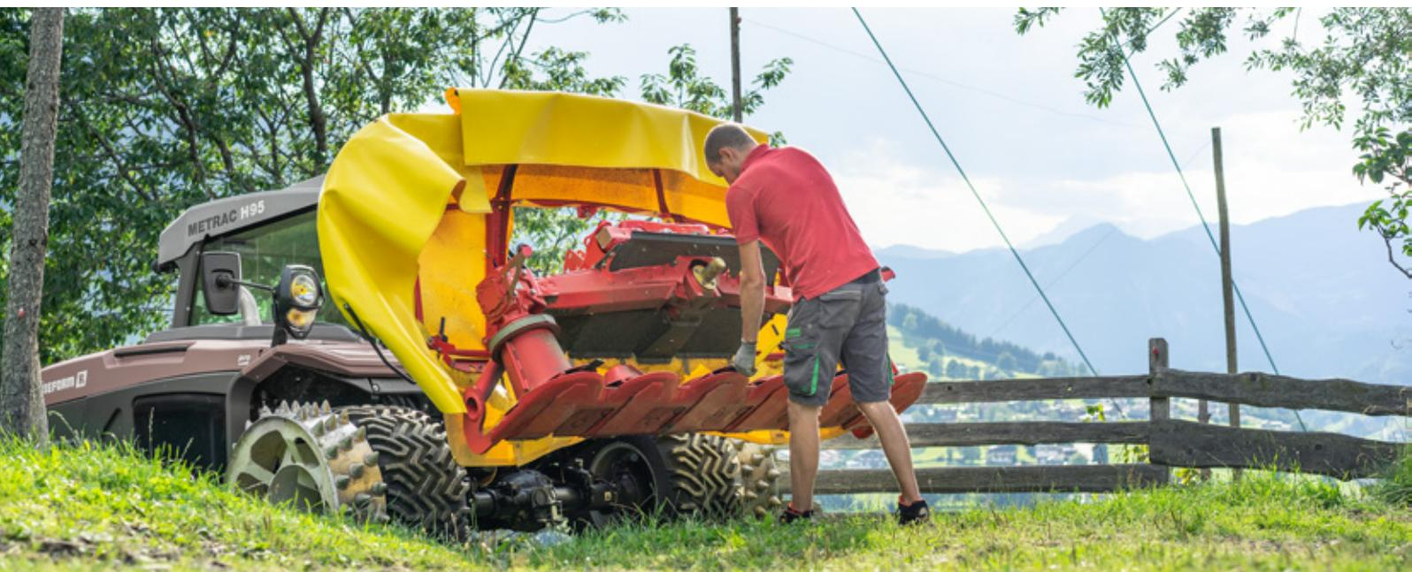
Grâce au repliage facile des protections, l'accès au lamier par tous les côtés est garanti de manière très confortable. L'ensemble des protections de la NOVACAT F ALPIN se replie par une seule manœuvre. Des amortisseurs efficaces vous accompagnent et maintiennent les protections en position relevée. Rien n'entrave le changement rapide des couteaux.
