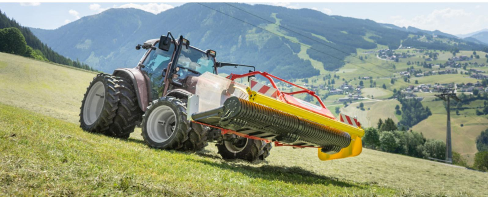
Trois patins palpent le sol et guident parfaitement l'andaineur à tapis sur toutes les inégalités du sol. La hauteur de ratissage peut être pré-réglée à l'aide de cales et ajustée avec précision grâce à la longueur du 3ème point. La suspension du Merger fonctionne soit par le biais de la suspension du relevage du tracteur, soit en option, par le biais de deux puissants ressorts disposés entre la tête d'attelage de l'andaineur à tapis et la console du tracteur.
