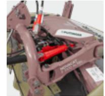
**Spostamento idraulico laterale**
