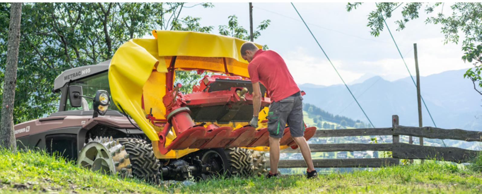
La barra falciante è facilmente accessibile da qualsiasi parte grazie al ribaltamento dei teli di protezione, facilmente comandabile. Come in un cofano, nella NOVACAT F ALPIN tutte le protezioni sono ribaltabili con un solo gesto. Potenti ammortizzatori a gas vi supportano nel farlo e mantengono i teli di protezione in posizione aperta. Così è possibile sostituire le lamette in modo semplice e rapido.
