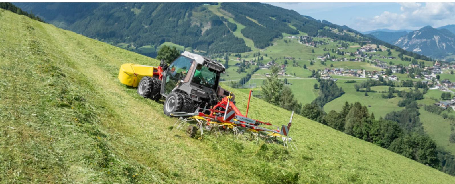
I due modelli HIT V ALPIN a 4 giranti sono dei veri e propri pesi leggeri. A seconda del modello, lo spandivoltafieno con attacco a 3 punti fisso pesa solo 320 kg. Il modello con cavalletto sterzante pesa solo 390 kg. Entrambi gli spandivoltafieno raggiungono una larghezza di lavoro DIN di 4,20 m.
