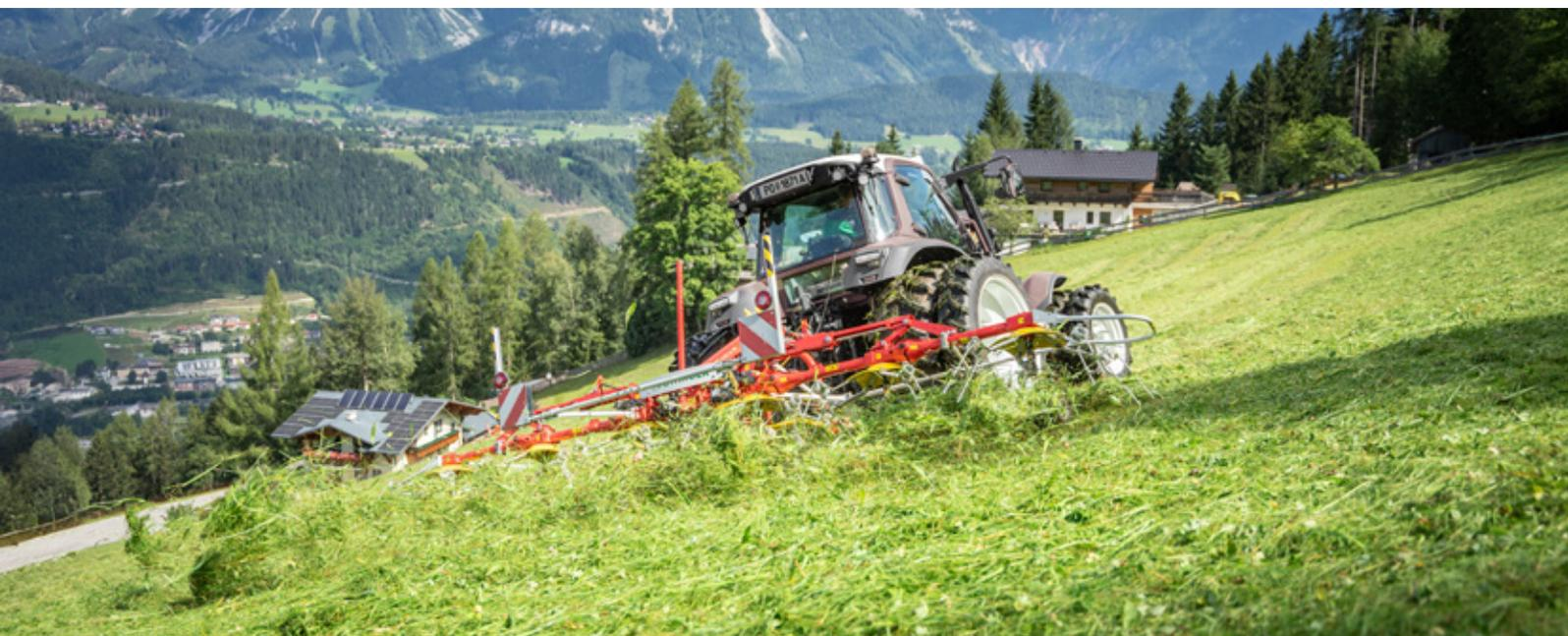
Nello spandivoltafieno HIT V 6260 ALPIN leggerezza e perfetto adattamento al terreno sono prioritari. Con una larghezza di lavoro DIN di 6,20 m ed un peso di soli 530 kg è un peso leggero molto efficiente. HIT V 6260 ALPIN è dotato di serie di un cavalletto sterzante. HYDROLIFT garantisce una sufficiente libertà dal suolo a fine campo.
