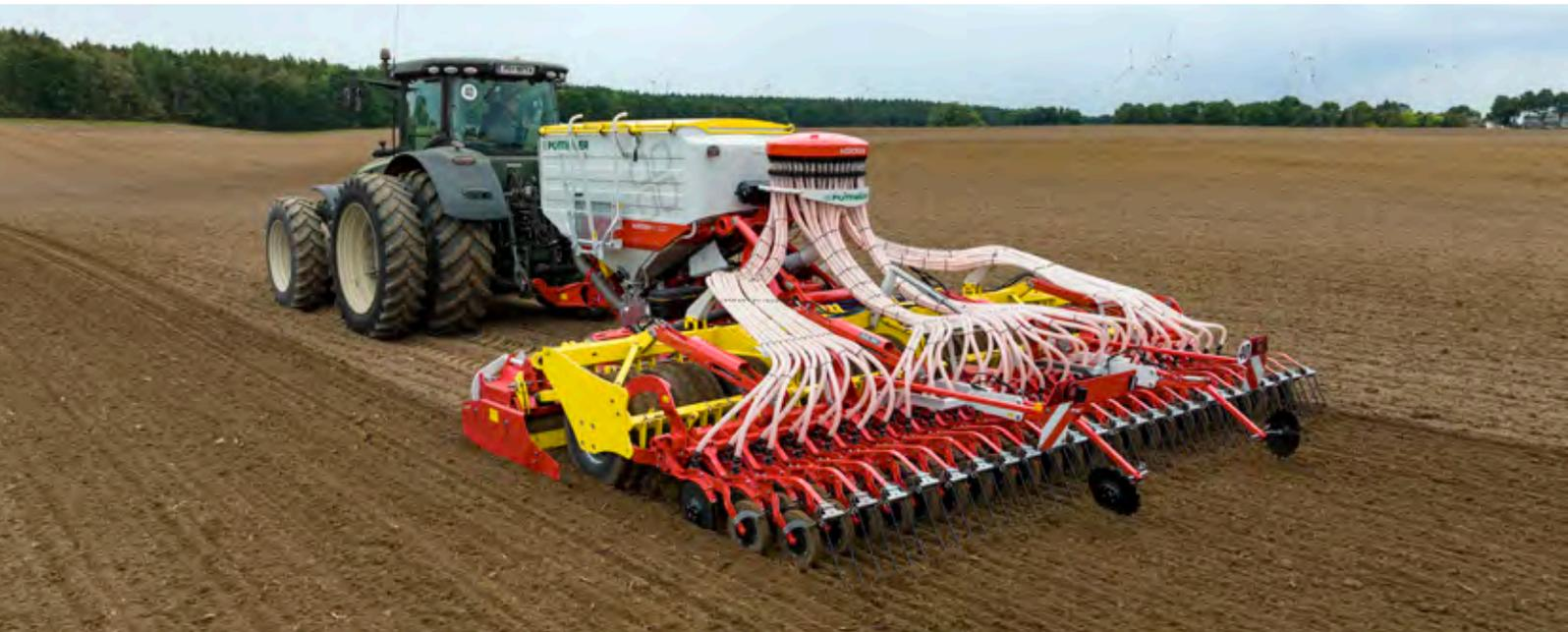
Die gezogenen AEROSEM Säkombinationen mit aktiver Bodenbearbeitung vereinen die Saatbettbereitung mit LION Kreiselegge, die Rückverfestigung mit Rillenreifenpacker und die Aussaat mit der DUAL DISC Säschiene. Das gezogene Sämaschinen-Konzept wurde für leichte bis hin zu schwersten Bodenarten entwickelt und wird erweitert durch die Profiline Komfortsteuerung. Diese ermöglicht die Ansteuerung aller hydraulischen Funktionen inklusive Scharndruckverstellung, bequem von der Fahrerkabine aus.
