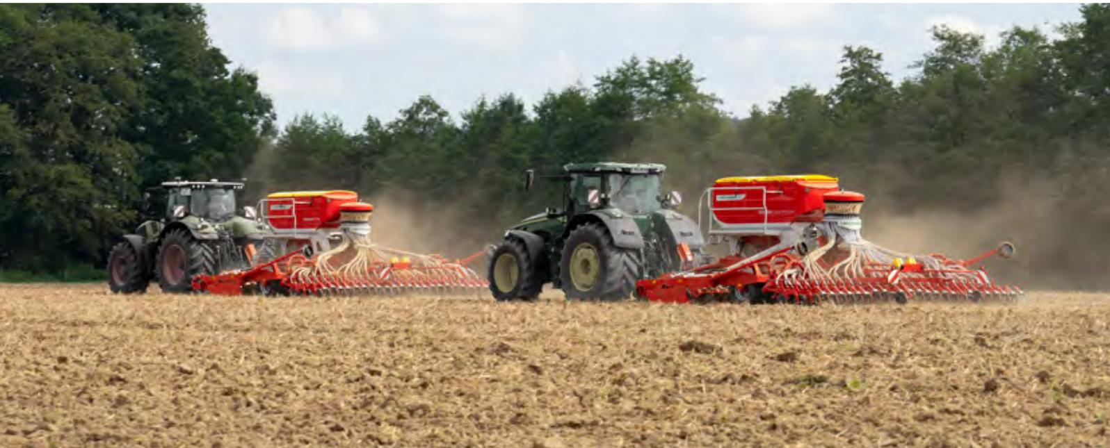
Das TERRASEM Universalsätechnik-Konzept vereint die Arbeitsschritte Bodenbearbeitung, Rückverfestigung und Saat in einer Maschine: die perfekte Kombination aus Schlagkraft, höchster Einsatzsicherheit und präziser Saatgutablage für Ihre Bedürfnisse. Erweitert durch die Profiline Komfortsteuerung, wird es ermöglicht alle hydraulischen Funktionen bequem von der Fahrerkabine aus anzusteuern.
