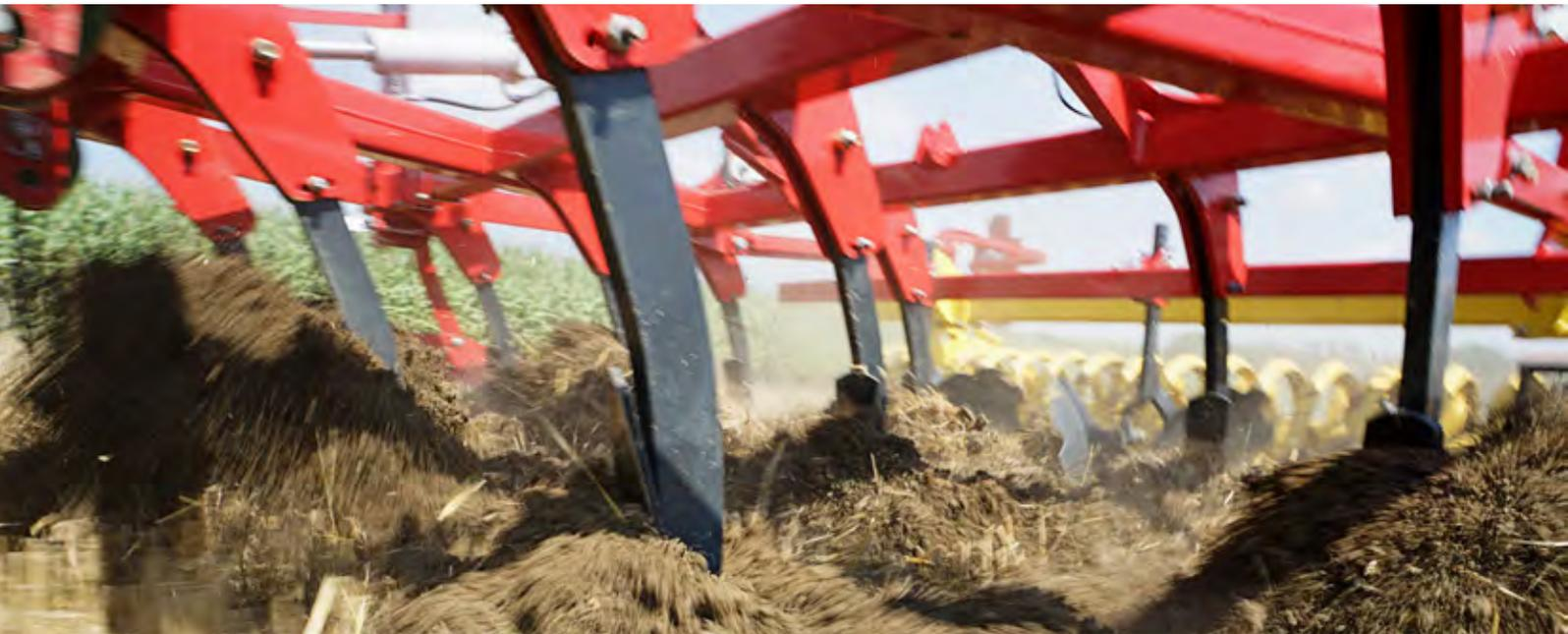
Die PÖTTINGER SYNKRO Grubber wurden für den zeitgemäßen Stoppelsturz entwickelt und eignen sich für die flache als auch tiefe Bodenbearbeitung. Bei der Konstruktion wurde besonders auf Leichtzügigkeit und geringen Kraftbedarf Wert gelegt.
