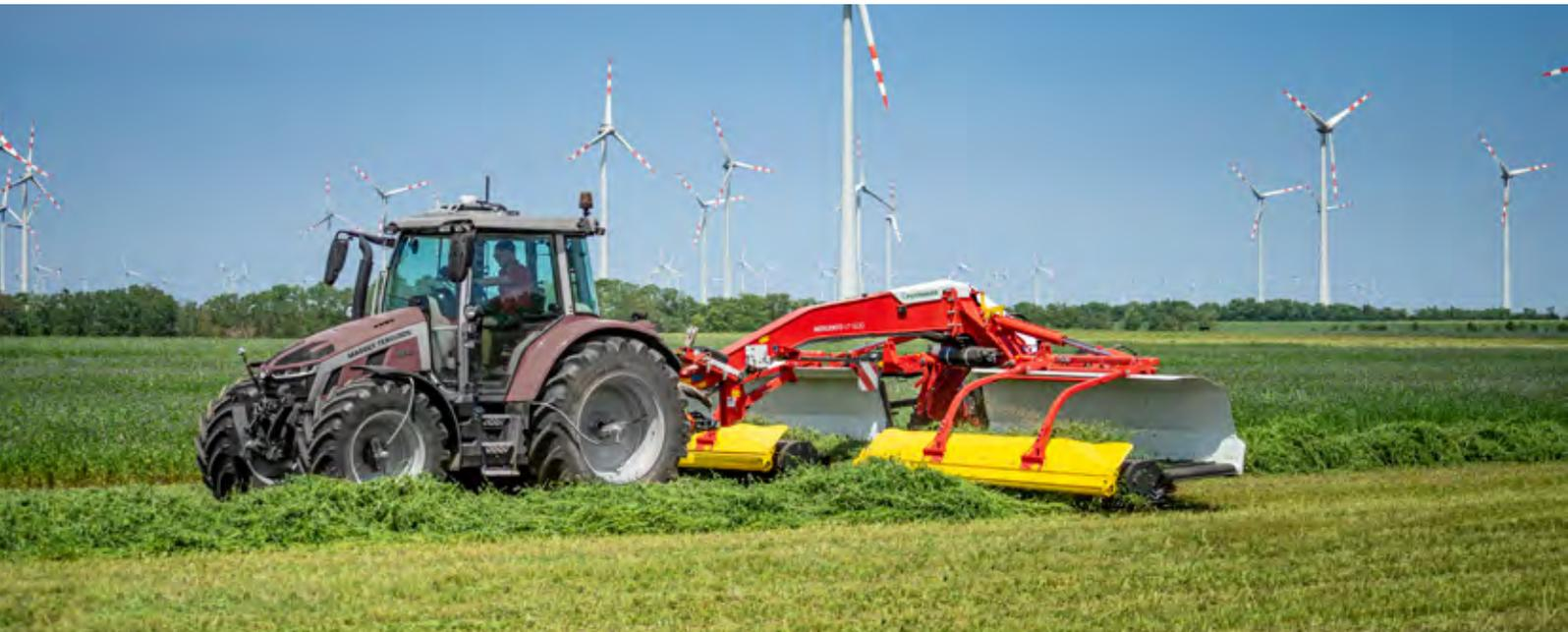
MERGENTO nimmt das Futter über die Pick-up vom Boden auf. Ohne weiteren Bodenkontakt wird es schonend über Querförderbänder Richtung Schwad transportiert und dort abgelegt. Schmutz und Steine bleiben am Boden liegen. Bröckelverluste werden auf ein Minimum reduziert.
