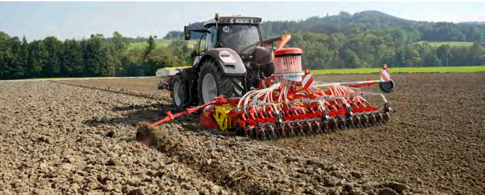
Avec le semoir à trémie frontale AEROSEM F, PÖTTINGER élargit sa gamme de semoirs pneumatiques des largeurs de travail de 3 à 6 mètres.
