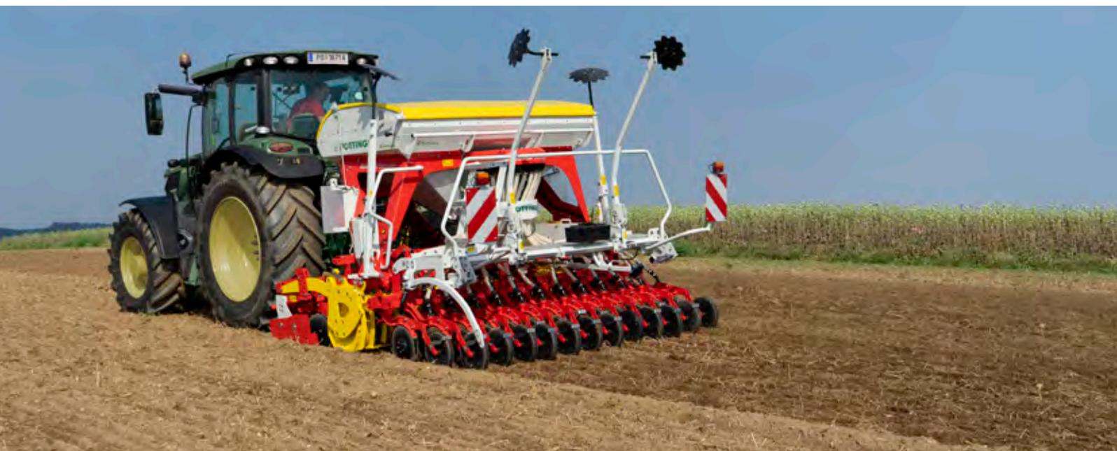
Le concept unique des semoirs pneumatiques AEROSEM permet à la fois le semis de céréales et le semis monograine du maïs. La distribution précise et universelle et les éléments de semis performants garantissent une dépose précise de la semence.
