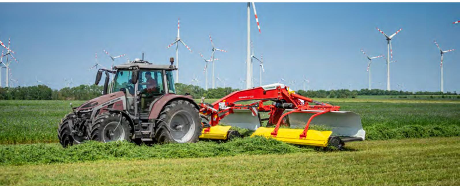
Le pick-up du MERGENTO prélève le fourrage de la couche végétale. Il est ensuite transporté délicatement par les tapis pour être déposé en andain, sans autre contact avec le sol. La terre et les pierres restent au sol. Les pertes par effeuillage sont réduites au minimum.
