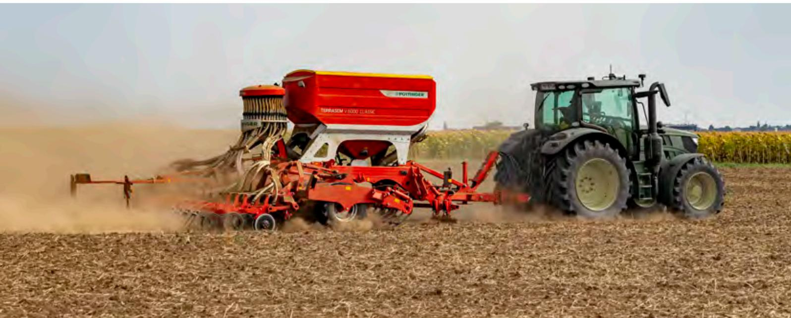
Les TERRASEM V CLASSIC sans disques déchaumeurs offrent une solution performante sur les grandes surfaces avec moins de puissance consommée. Pour cela, le lit de semence doit être bien préparé – cette préparation ayant lieu avant le semis. Grâce à l'adaptation au sol optimale et le rouleau packer à pneu unique en son genre, une dépose parfaite de la semence est réalisée dans un lit de semence parfaitement rappuyé.
