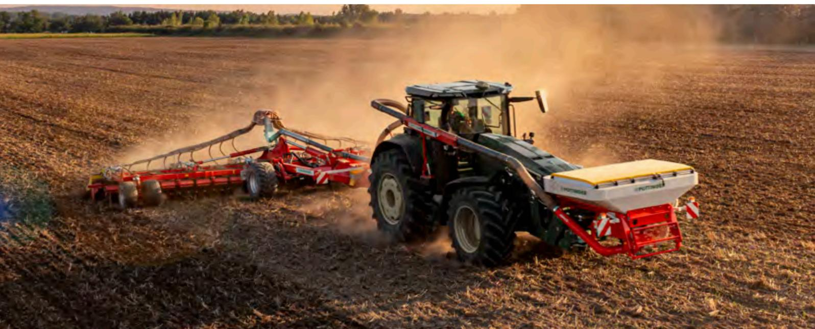
Associée à différentes machines, la trémie frontale AMICO permet de semer de l'engrais ou des microgranulés, des cultures intermédiaires ou deux composants à la fois. Avec une capacité de 1 700 ou 2 400 litres et une répartition du volume de 60/40, une large plage d'utilisation est garantie.
