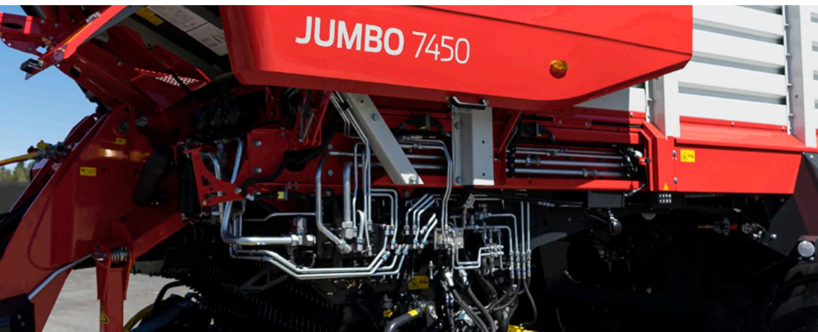
Благодаря разделению гидравлики и электрики прицеп-подборщик проще и удобнее содержать в чистоте. Упорядоченное расположение кабелей способствует поиску неисправностей и сокращению времени простоя.
