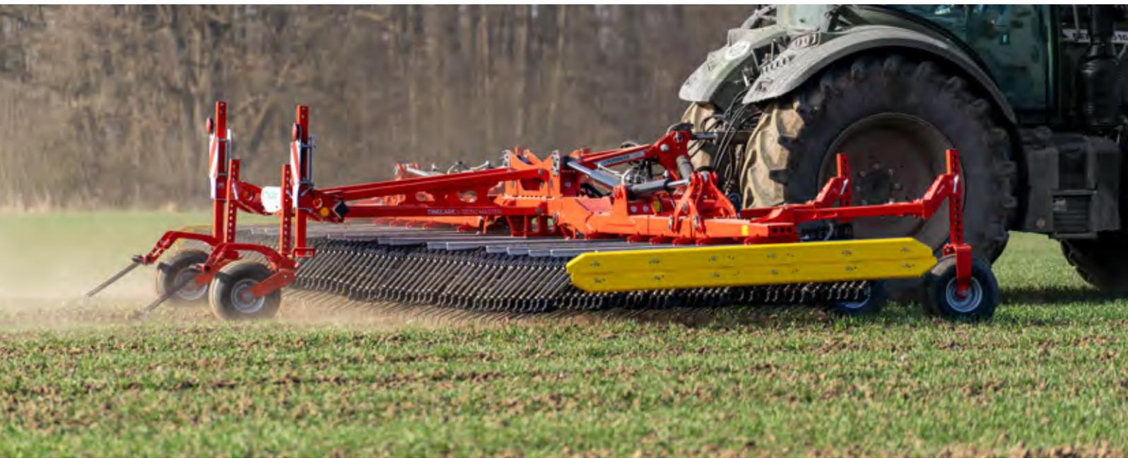
Der Rahmen des TINECARE V ist verwindungsfrei und robust konzipiert. Mit einer Dimension von 120 mm x 180 mm ist er über die volle Arbeitsbreite ausbalanciert. Das ist die Basis für höchste Arbeitsqualität und einen ruhigen Lauf, auch bei höheren Arbeitsgeschwindigkeiten und maximalem Zinkendruck.
