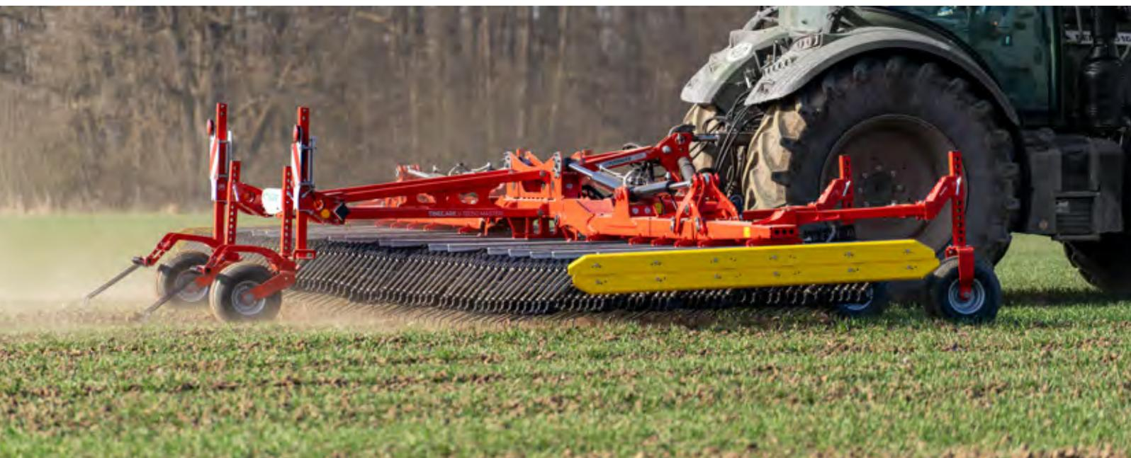
Le châssis de la TINECARE V est particulièrement robuste et résistant à la torsion. Avec une dimension de 120 mm x 180 mm, il est uniforme sur toute la largeur de travail. C'est la base d'une qualité de travail maximale et d'un fonctionnement stable, même à des vitesses de travail élevées et avec une pression maximale des dents.
