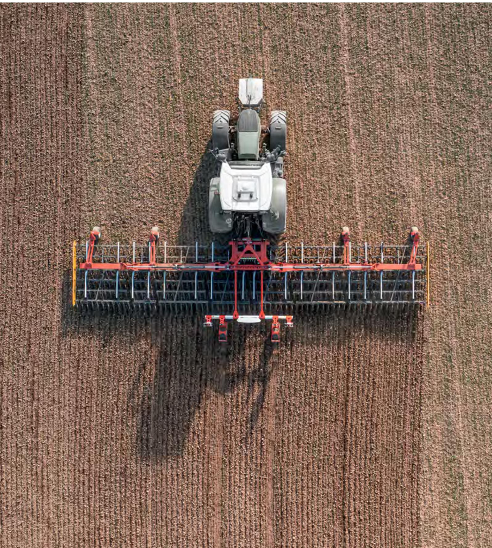
Les quatre roues de jauge avant sont réglables de série latéralement et en hauteur. Elles permettent ainsi une parfaite adaptation au sol. Lorsqu'elles sont utilisées dans les cultures en ligne, elles sont toujours placées entre les rangées de plantes.
