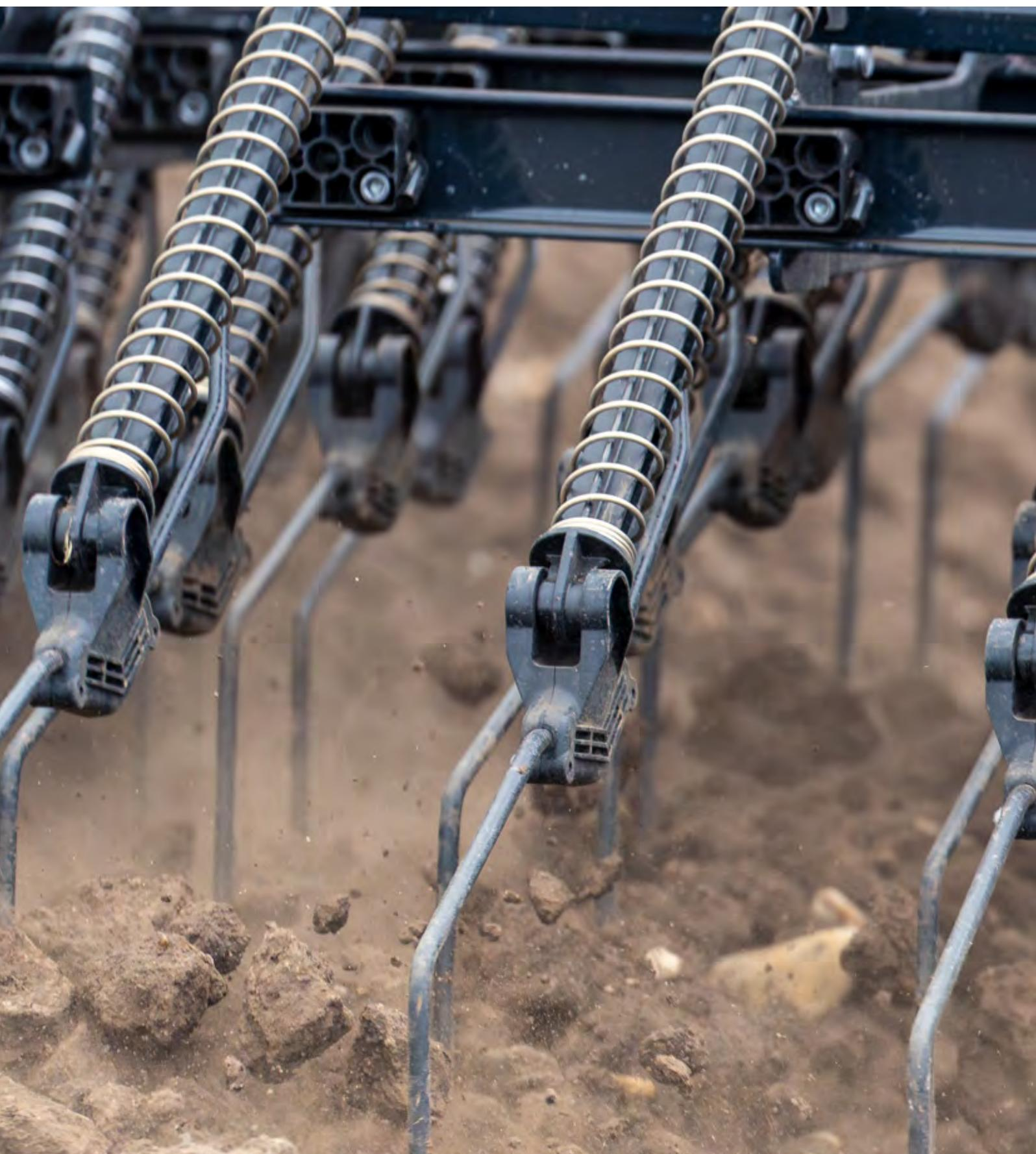
Les éléments de dents de la TINECARE V séduisent par leur structure simple, légère et respectueuse de la culture. La fixation indirecte de la dent de herse est équipée d'un ressort de pression en spirale. Sa disposition au-dessus de la dent empêche les pièces en mouvement de blesser les plantes cultivées, même déjà bien développées.
