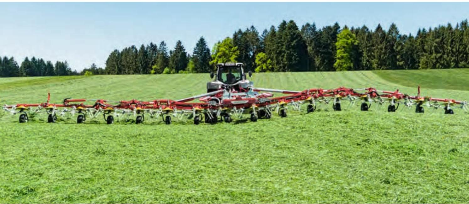
Obraceče HIT se vyznačují především dokonalým kopírováním nerovností. Jak u nesených, tak i polonesených obracečů reagují čelní kopírovací kolečka v blízkosti prstů citlivě na jakékoli nerovnosti. Kromě toho se všechny spoje rámu přizpůsobují každému obrysu nezávisle na sobě. S touto profesionální variantou lze dosáhnout vyšších pracovních rychlostí a i větší plošné výkonnosti. To umožňuje šetrnou manipulaci se sklízeným materiélem při minimalizaci znečištění.
