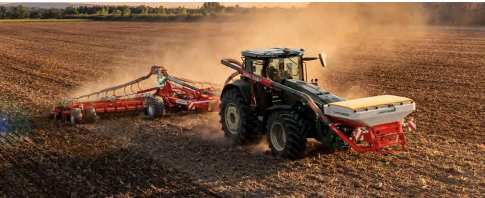
Čelní zásobník AMICO ve spojení s různými zemědělskými stroji nabízí možnost aplikace hnojiva nebo mikrogranulí, meziplodin nebo dvou komponent současně. S objemem 1 700 nebo 2 400 litrů a rozložením objemu 60:40 je široká škála použití zaručena.
