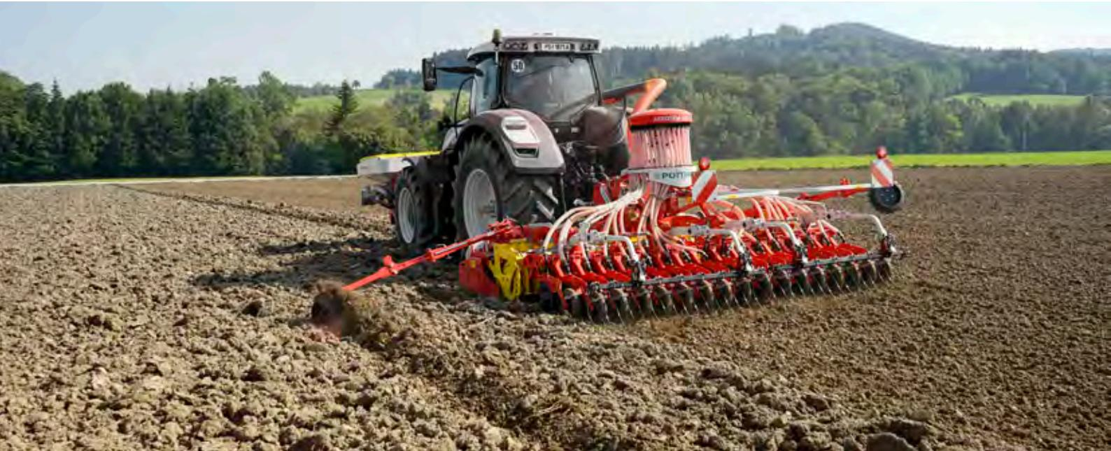
Se stroji AEROSEM F rozšiřuje PÖTTINGER svoji nabídku pneumatických secích strojů s čelním zásobníkem s pracovním záběrem od 3 do 6 metrů.
