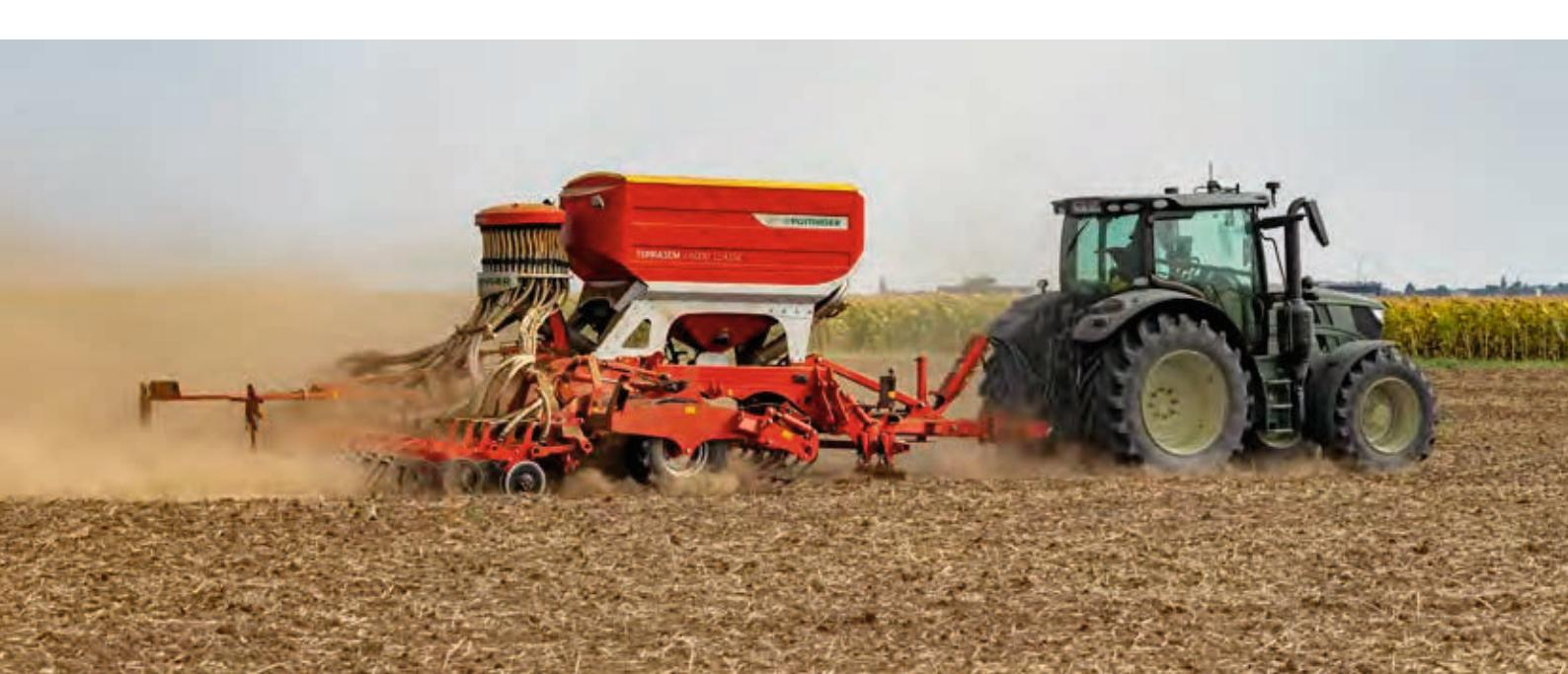
Modely TERRASEM CLASSIC bez čelních nástrojů pro zpracování půdy nabízí výkonnostní technologii uložení osiva. Minimalizační technologie setí s menší energetickou náročností. Díky optimálnímu přizpůsobení secí lišty půdě a jedinečnému pneumatikovému válci je dosaženo dokonalého ukládání osiva v požadované hloubce.
