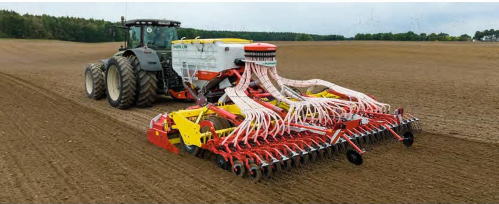
Tažený secí stroj AEROSEM VT kombinuje aktivní přípravu seťového lůžka rotačními branami LION, opětovné utužení pomocí válců a uložení osiva botkou DUAL DISC. Koncept taženého secího stroje s rotačními bránami byl vyvinut pro lehké až nejtěžší typy půd a je rozšířen o komfortní ovládání Profiline. To umožňuje pohodlné ovládání všech hydraulických funkcí včetně nastavení přitlaku botek z kabiny řidiče.
