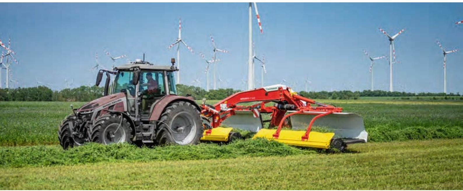
MERGENTO šetrně sbírá píci řízeným sběračem. Bez dalšího kontaktu se zemí je píce šetrně dopravována příčními pásy a odkládaná do řádku. Na zemi zůstávají nečistoty a kameny. Ztráty v důsledku odrolu jsou minimalizované.
