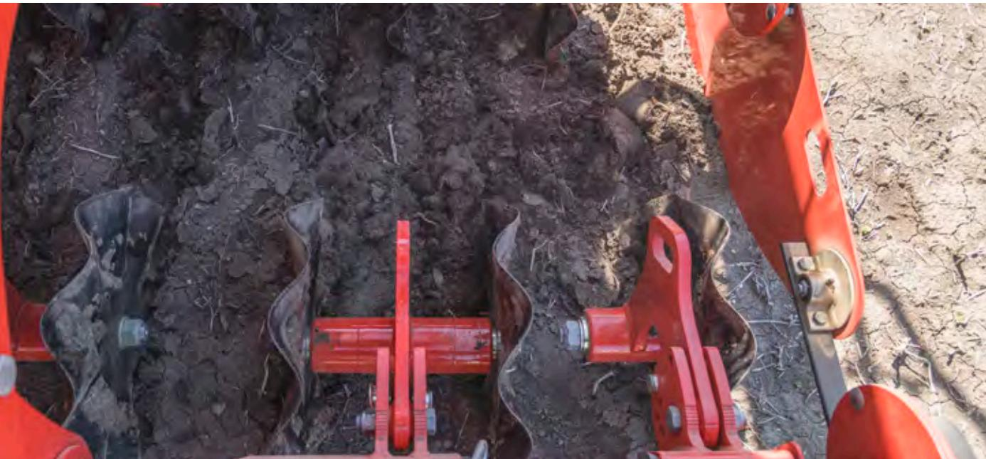
Bezúdržbový systém WAVE DISC je tvořený tvarovanými disky o průměru 510 mm s roztečí 12,5 cm nebo 16,7 cm. Plynulé nastavení pracovní hloubky. Systém redukovaného zpracování půdy v pásech představuje také účinné protierozní opatření. Vhodné především pro oblasti s extrémními podmínkami – těžké, mokré a lepivé půdy. WAVE DISC jsou k dispozici pro všechny modely secích strojů TERRASEM.
