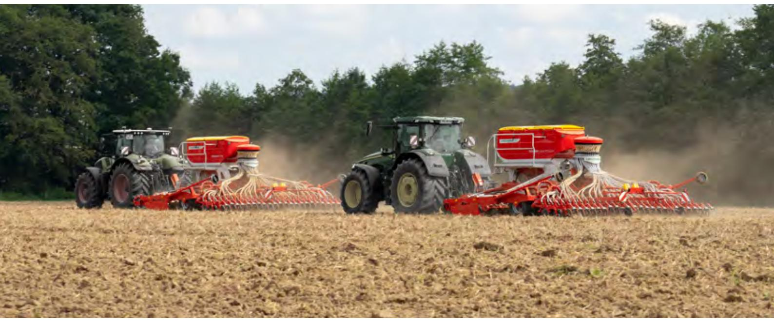
Koncept secích strojů TERRASEM firmy PÖTTINGER kombinuje pracovní kroky přípravy seťového lůžka s opětovným utužením a setí při jednom přjezdu. Dokonalé sladění efektivity a přesného uložení osiva dle Vašich potřeb. Rozšířené o komfortní ovládání Profiline je možné ovládat všechny hydraulické funkce pohodlně z kabiny řidiče.
