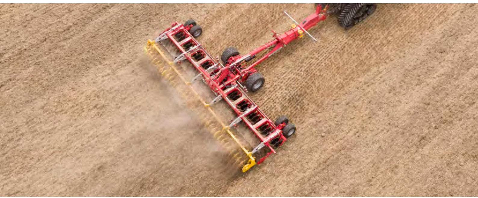
V moderní rostlinné výrobě nové systémy obdělávání půdy zintenzivnily trend k minimální míře tohoto obdělávání. Po žních je nutno posklizňové zbytky na celé ploše zpracovat tak, aby mohl proces rozkladu brzy započít. Tato směs rostlinných zbytků se zeminou vytváří optimální podmínky života pro živé organismy v půdě. TERRADISC je univerzálně použitelný a lze ho využívat i k úpravě osevních ploch přímo před setím.
