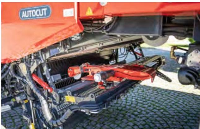
Un corte exacto y uniforme es la base para conseguir la mejor calidad de ensilado. El dispositivo de afilado de cuchillas AUTOCUT asegura una calidad de corte duradera durante todo un día de trabajo.
