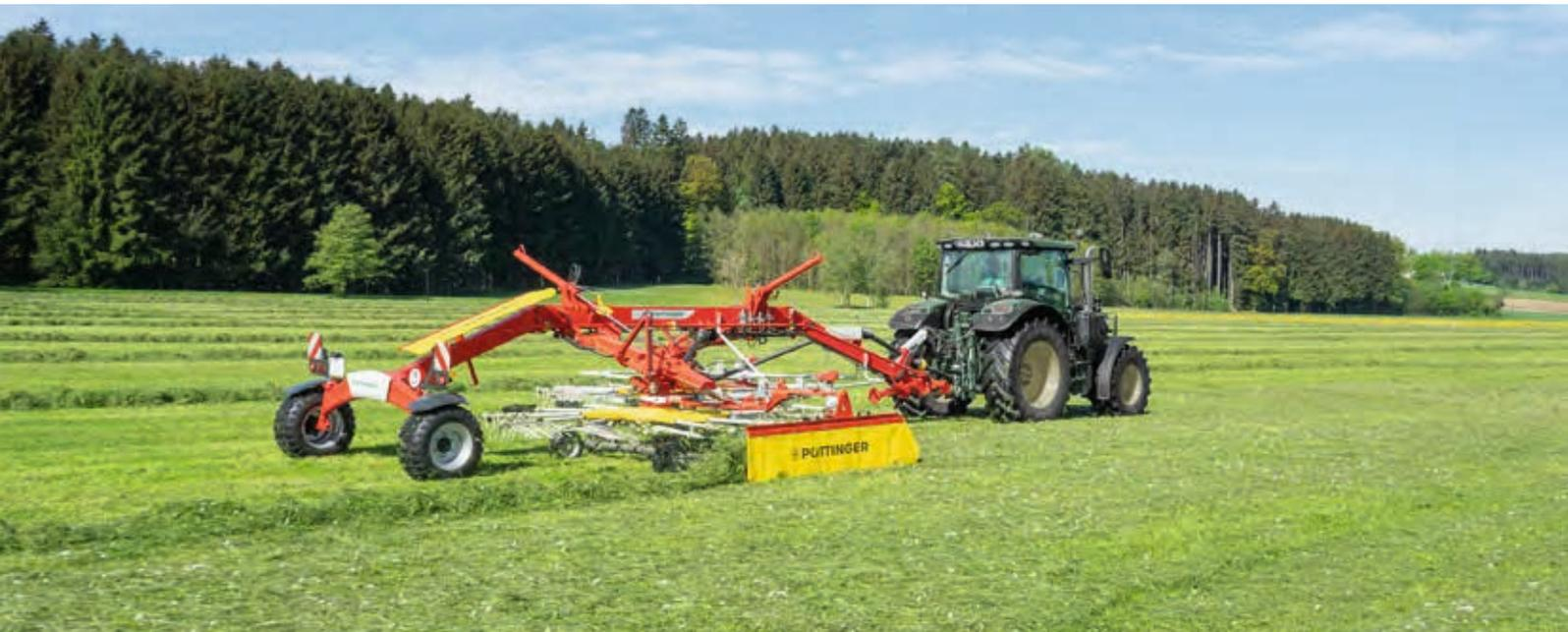
Un trabajo de rastra exacto y escasa contaminación del forraje – es el sinónimo para los rastrillos hileradores TOP de PÖTTINGER. Una adaptación al suelo ideal gracias a la rueda única MULTITAST sienta las bases para ello. La técnica de robustos rotores TOPTECH PLUS de grandes dimensiones aportan además una larga vida útil y un mantenimiento fácil.
