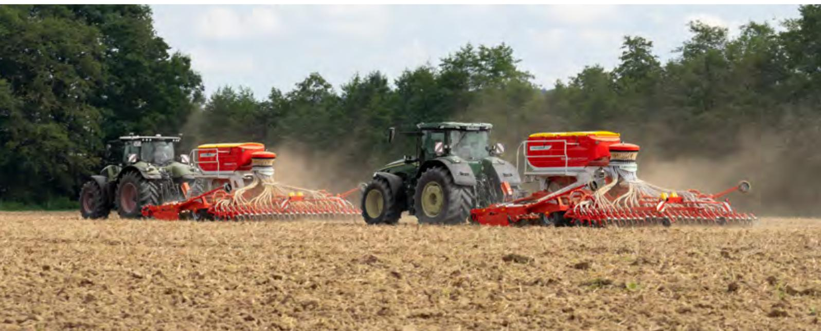
La técnica de sembradora universal TERRASEM de PÖTTINGER une los pasos de trabajo de laboreo del suelo, compactación y siembra en una sola máquina: la perfecta combinación de potencia, la máxima seguridad de uso y el depósito preciso de la semilla para sus necesidades. Ampliado con el mando confort Profiline es posible controlar todas las funciones hidráulicas de forma cómoda desde la cabina.
