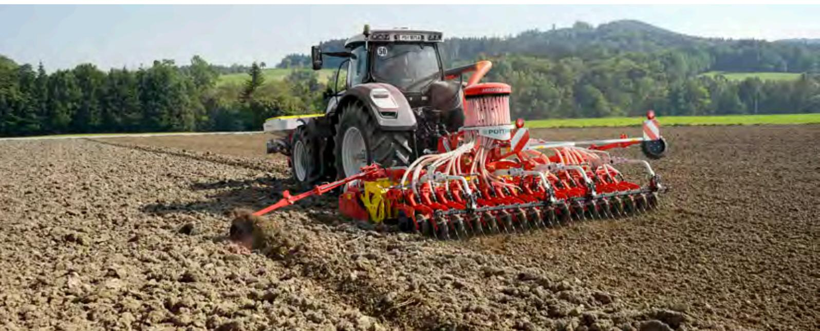
Con la sembradora con depósito frontal AEROSEM F, PÖTTINGER amplía la gama de sembradoras neumáticas suspendidas con un ancho de trabajo de 3 m hasta 6 metros.
