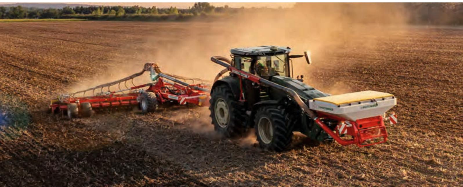
El depósito AMICO ofrece, en combinación con diferentes máquinas de laboreo, la posibilidad de esparcir por ejemplo microgranulados, cultivos de cobertura o dos componentes al mismo tiempo. Con una capacidad de 1.700 o 2.400 litros y una división de volumen de 60:40 se garantiza un amplio espectro de uso.
