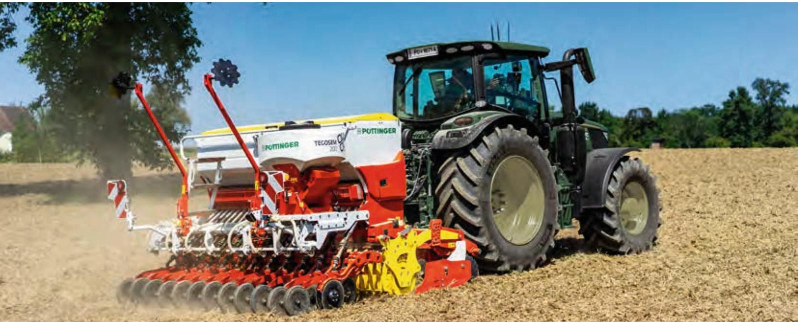
El depósito flexible TEGOSEM combina el laboreo del suelo y el esparcido de frutos intermedios, microgranulado o siembra inferior en una sola pasada, ahorrando tiempo y gastos. La TEGOSEM se puede combinar con máquinas suspendidas y arrastradas.
