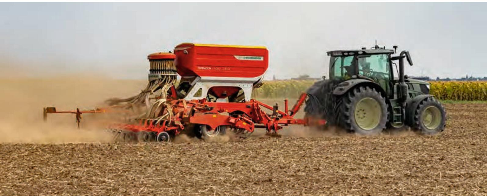
Los modelos TERRASEM V CLASSIC sin herramientas previas ofrecen una técnica de grandes superficies de fácil arrastre y potente. El semillero va nivelado de forma óptima, y la preparación del semillero se lleva a cabo antes de la siembra. Gracias a la adaptación óptima al suelo de la barra de siembra y el rodillo único se consigue un depósito perfecto de la semilla en el semillero compactado.
