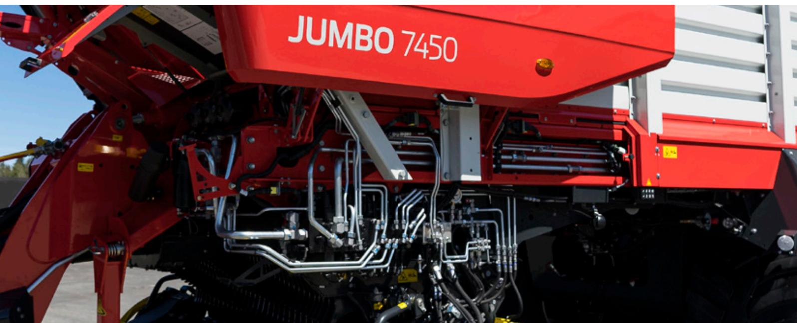
La división de hidráulica y electrónica hace mucho más simple y fácil la limpieza del remolque autocargador. La ubicación sencilla de los conductos ayuda durante la búsqueda de errores y se reduce el tiempo de parada.
