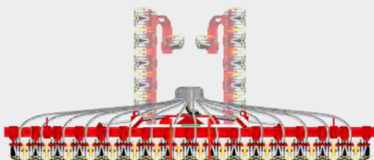
Fordelersystem med 16 udløb og enkel slangeføring
