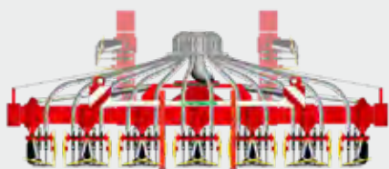
Fordelersystem med 12 udgange
