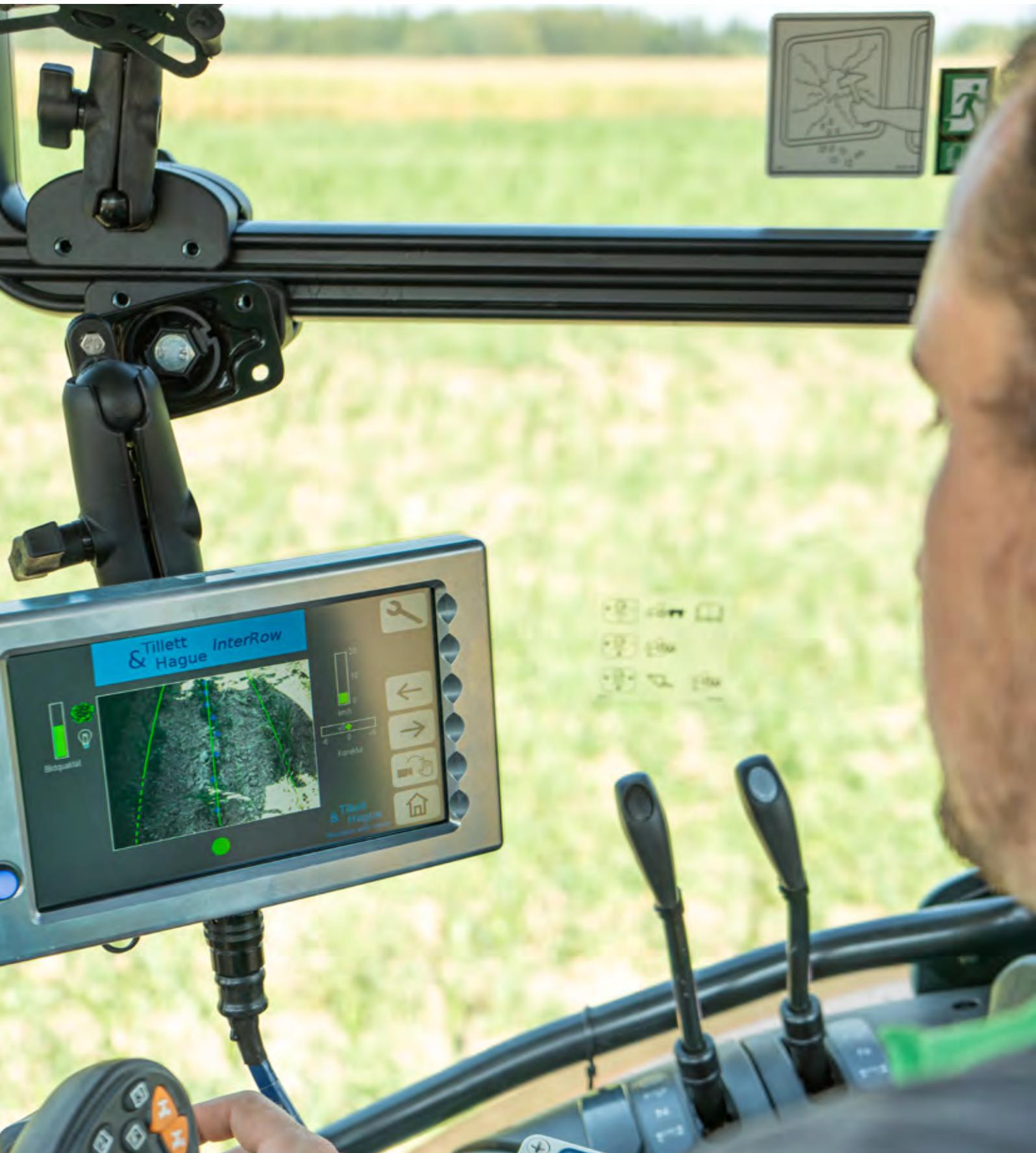
Поднятие элементов рыхления на разворотных полосах снижает наложения и повторную обработку. Для этого есть два способа управления: централизованный подъем или отдельный подъем.
