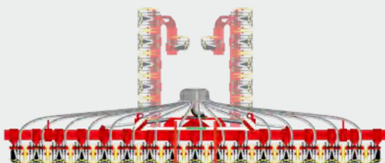
Распределительная система с 16 выходами и простыми шлангами
