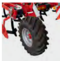
Ruote tastatrici idrauliche (ruota tast. singola) 11.5/80-15,3
