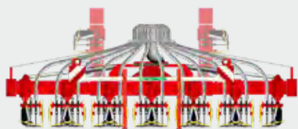
Distribuční systém se 12 vývody
