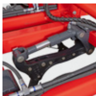
Hydraulické NONSTOP jištění radliček
