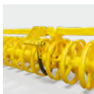
Dents de nivellement entre les rouleaux
