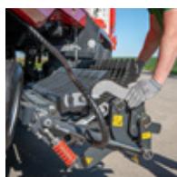
Ribaltamento idraulico del gruppo di taglio con EASY MOVE
