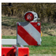
Warntafel mit Beleuchtung
