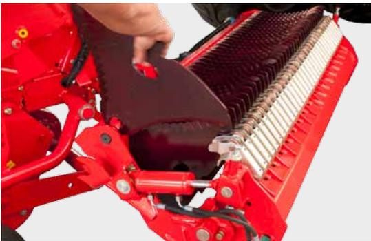
Durch einen Druck auf die Aktivierungstaste für die zentrale Messerentriegelung werden die Messer freigegeben und können werkzeuglos entnommen werden.
