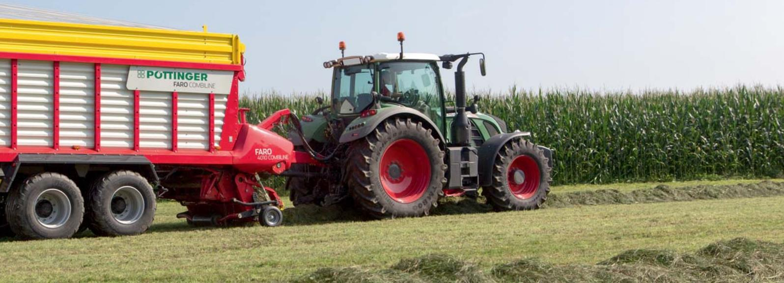
La carga automática garantiza un llenado completo y así una alta capacidad de transporte. El forraje se compacta cuidadosamente en el canal de alimentación y la caja de carga se llena completamente. De serie en FARO 4010 COMBILINE y FARO 8010.
