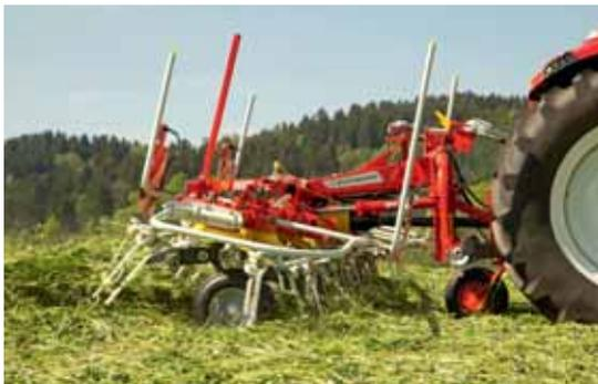
La adaptación al suelo y la protección del forraje es el alfa y omega en los rastrillos henificadores HIT. Una rueda palpadora opcional en el bloque de giro sigue el contorno del suelo un poco antes de las púas y reacciona ante el más mínimo desnivel. El resultado: un forraje limpio, con menos partes anorgánicas y mejor salud de los animales.
