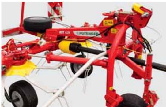
Estos rastrillos henificadores con un ancho de trabajo (DIN) de 4,40 m y 5,20 m tienen una construcción muy compacta y son extremadamente aptos para pendientes. Diseño compacto. Los 6 brazos portapúas de cada rotor garantizan un óptimo esparcido con cada forraje.
