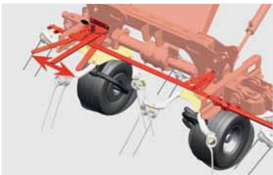
Gracias a la inclinación de las ruedas, el rastrillo henificador va transversal al suelo y esparce el forraje uniformemente. Las hileras próximas quedan sin tocar. Por el ajuste de las ruedas hacia la izquierda o la derecha, el henificado marginal es posible en cualquier dirección.
