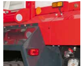
Oświetlenie graniczne i obrysowe
