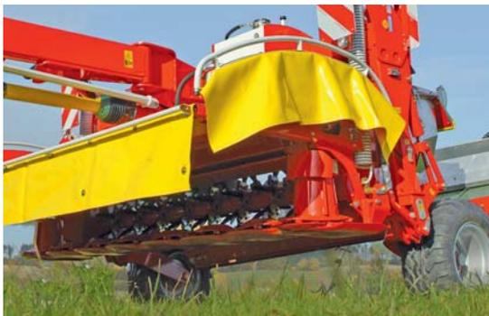
**El núcleo de las segadoras de discos de PÖTTINGER es la eficiente barra de corte. Las barras de corte de las segadoras de discos NOVACAT se desarrollan y fabrican completamente en Grieskirchen – un producto de calidad austriaca. Un corte de primera calidad, el fácil arrastre y la estabilidad son el sello de las barras de corte. Los detalles constructivos garantizan un funcionamiento fiable y contribuyen considerablemente a la larga vida útil.**
