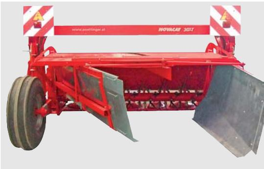
**También se puede agrupar de una forma económica las hileras de forraje cortado con las aletas hidráulicas a través de chapas de ajuste hidráulico.**
