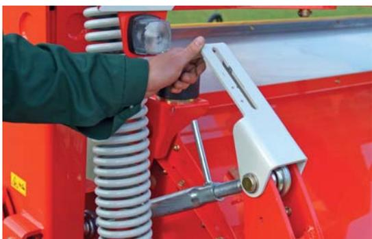
La altura de corte puede ajustarse de forma rápida y sencilla a través del brazo superior. Este brazo está asegurado contra cualquier desajuste accidental mediante una solapa. La indicación de altura de corte va integrado en la solapa.
