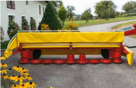
Räumtrommeln sorgen beidseitig für gute Schwadablage und saubere Spurräumung. Eine Teilung erreicht man durch zwei Fördertrommeln (optional). Der Traktor fährt somit nicht über den Schwad, sondern in der futterfreien Spur (NOVACAT 402 / 442).
