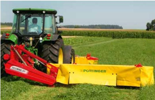
„Geringes Gewicht“ lautete vor allem die Devise bei der Entwicklung der NOVADISC Heckmäherwerke ohne Aufbereiter. Diese Leichtgewichte sind leichtzünftig und mit Arbeitsbreiten von 2,20 m bis 3,88 m für hohe Flächenleistung ausgelegt. Auch an Traktoren mit größeren Außenbreiten oder mit Zwillingsbereifung denken wir. Daher wurden zwei unterschiedliche Anbaumöglichkeiten entwickelt.
