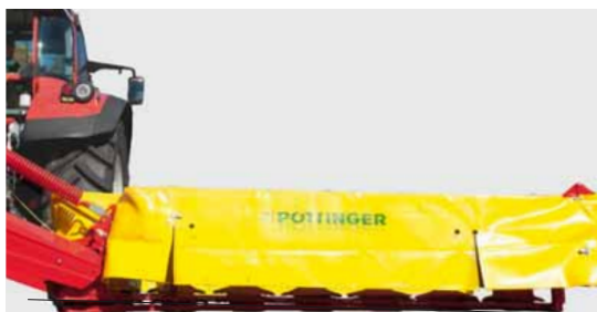
Belka podczas opuszczania najpierw osiada od zewnętrznej strony
