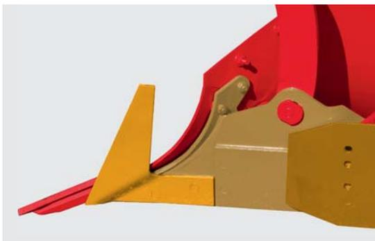
**Un corte limpio del disco de corte garantiza un volteo exacto de la franja de tierra y un perfecto despeje de los surcos.**
