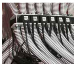
Kontrola przepływu nasion
