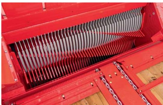
El pick up pendular de PÖTTINGER con ruedas palpadoras ajustables en altura de ambos lados aporta una perfecta adaptación al suelo que protege la capa de hierba. Las bajas revoluciones garantizan una recogida suave del forraje.
