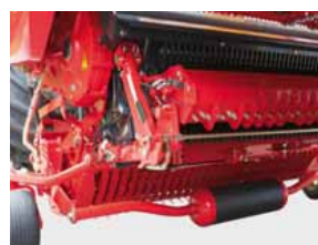
Rullo tastatore aggiuntivo per pick-up
