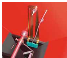
Kontrola stavu naplnění zásobníku a výsevního hřídele
