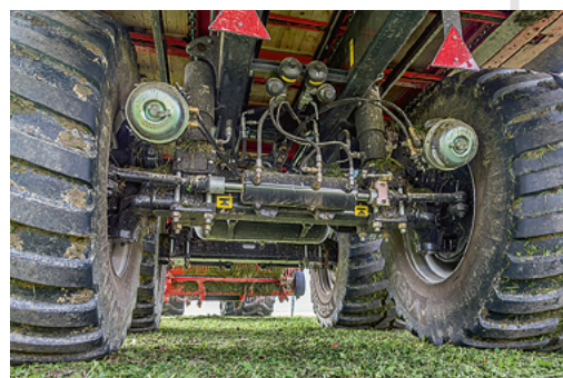
Das Fahrwerk hat Pöttinger mit einer breiteren Abstützung versehen.
