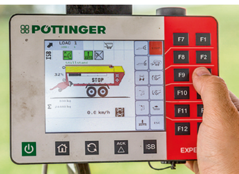
Eine ISO-Bus-Bedienung ist beim Jumbo Standard. Hier das Expert 75-Terminal.
