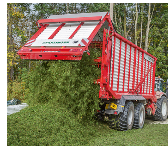
Der Antrieb der zwei oder drei Dosierwalzen ist auf 1 700 Nm erhöht worden.
