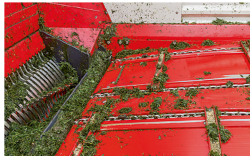
Der Kratzboden wurde nach vorne um 15 cm abgesenkt und ist je nach Modell sechsteilig.
