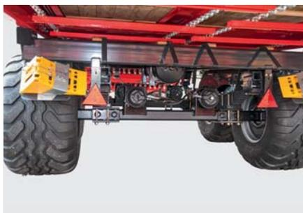
**Tandemachse mit Parabelfederung (optional), 13 t Achslast**
