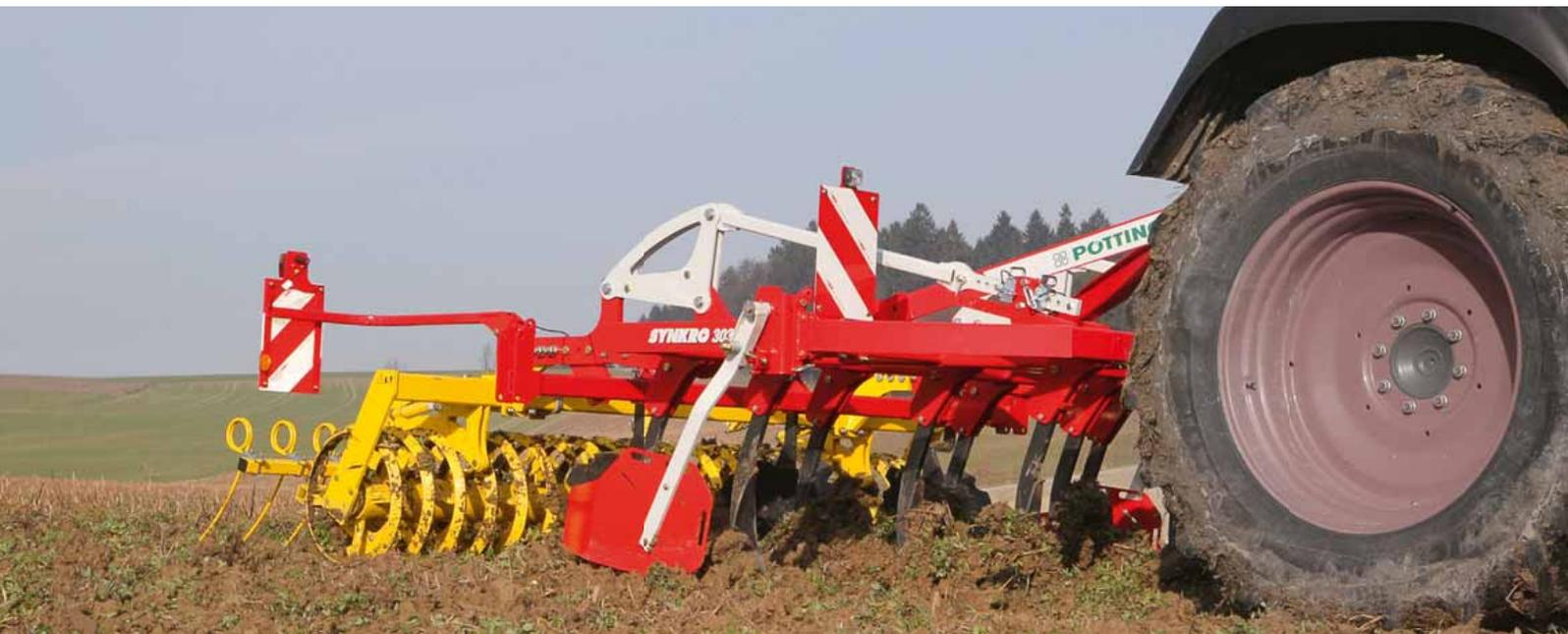
Die PÖTTINGER SYNKRO Grubber wurden für den zeitgemäßen Stoppelsturz entwickelt und eignen sich für die flache als auch tiefe Bodenbearbeitung. Bei der Konstruktion wurde besonders auf Leichtzügigkeit und geringen Kraftbedarf geacht
