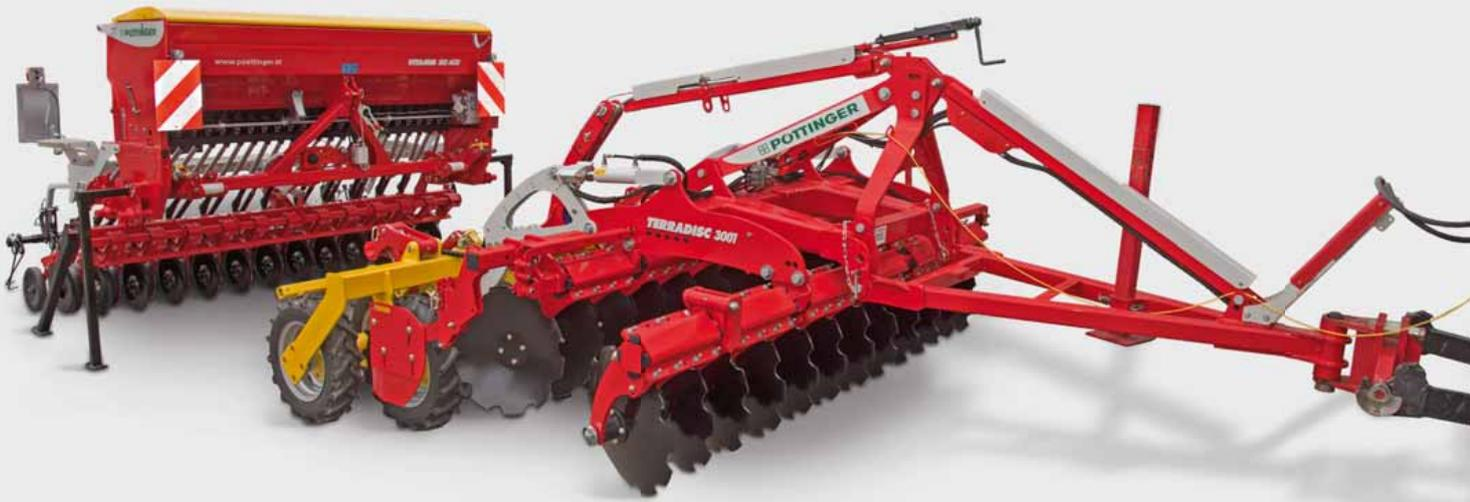
Vom Stoppelsturz zur Mulchsaat mit Aufbausämaschinen VITASEM ADD oder AEROSEM ADD. Innerhalb weniger Minuten entsteht aus der gezogenen TERRADISC Scheibenegge oder dem gezogenen SYNKRO Grubber eine wirtschaftliche, voll funktionstüchtige Mulchsaatmaschine.
