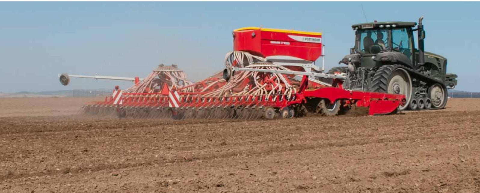
Das TERRASEM Mulchsaatkonzzept von PÖTTINGER vereint die Arbeitsschritte Bodenbearbeitung, Rückverfestigung und Saat in einer Maschine. Die effektive Kurzscheibenegge, der einzigartige Reifenpacker sowie die perfekte Säschiene sorgen für ein optimales Arbeitsergebnis.
