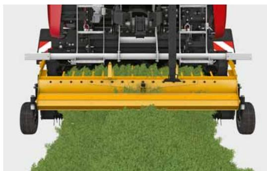
Inoltre le perdite per sbriciolamento vengono riconvogliate nel flusso del foraggio grazie al cosiddetto rotore di pulizia (pulitore) (1). Un'idea unica nel suo genere, che ha risolto brillantemente la problematica delle elevate perdite per sbriciolamento durante l'impiego con un numero elevato di coltelli. Ne risulta una prestazione elevata con contemporanea riduzione delle perdite per sbriciolamento.
